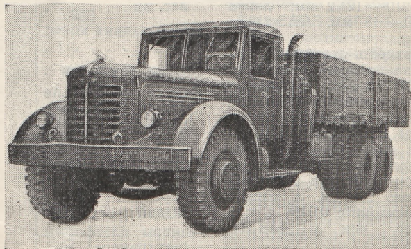
Рис. 1. Трехосный автомобиль ЯАЗ-210 грузоподъемностью 10 — 12 т.
