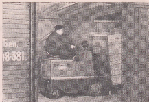
Рис. 4. Автопогрузчик 4004 во время работы по разгрузке вагонов.
