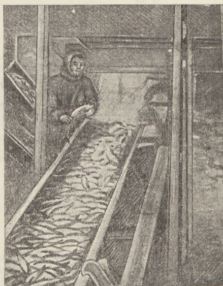
Рис. 1. Рыба на ленте транспортера под солевым бункером после прохождения «солевой завесы».
