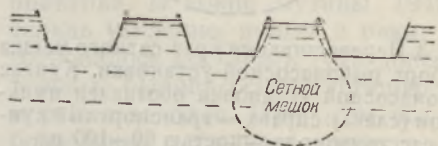
Рис. 1. Схема транспортировки сетного мешка двумя кунгасами. Пунктиром обозначен кунгас рыбонасосной установки.
