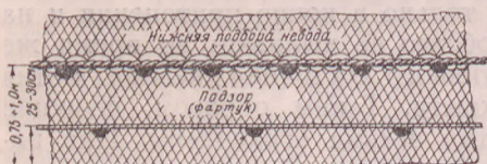
Рис. 3. Схема устройства подзора (фартука).
