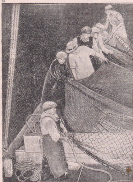
Рис. 3. Выборка и укладка невода на площадку на американском сейнере. На первом плане виден растительный стяжной трос, который укладывается вместе с нижней подборой.
