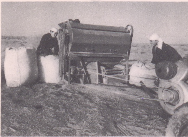
Специальный аппарат, сконструированный инженером Л. Крутиковым, очищает семена саксаула от крылышек-летучек, без которых они более пригодны для аэросева.
