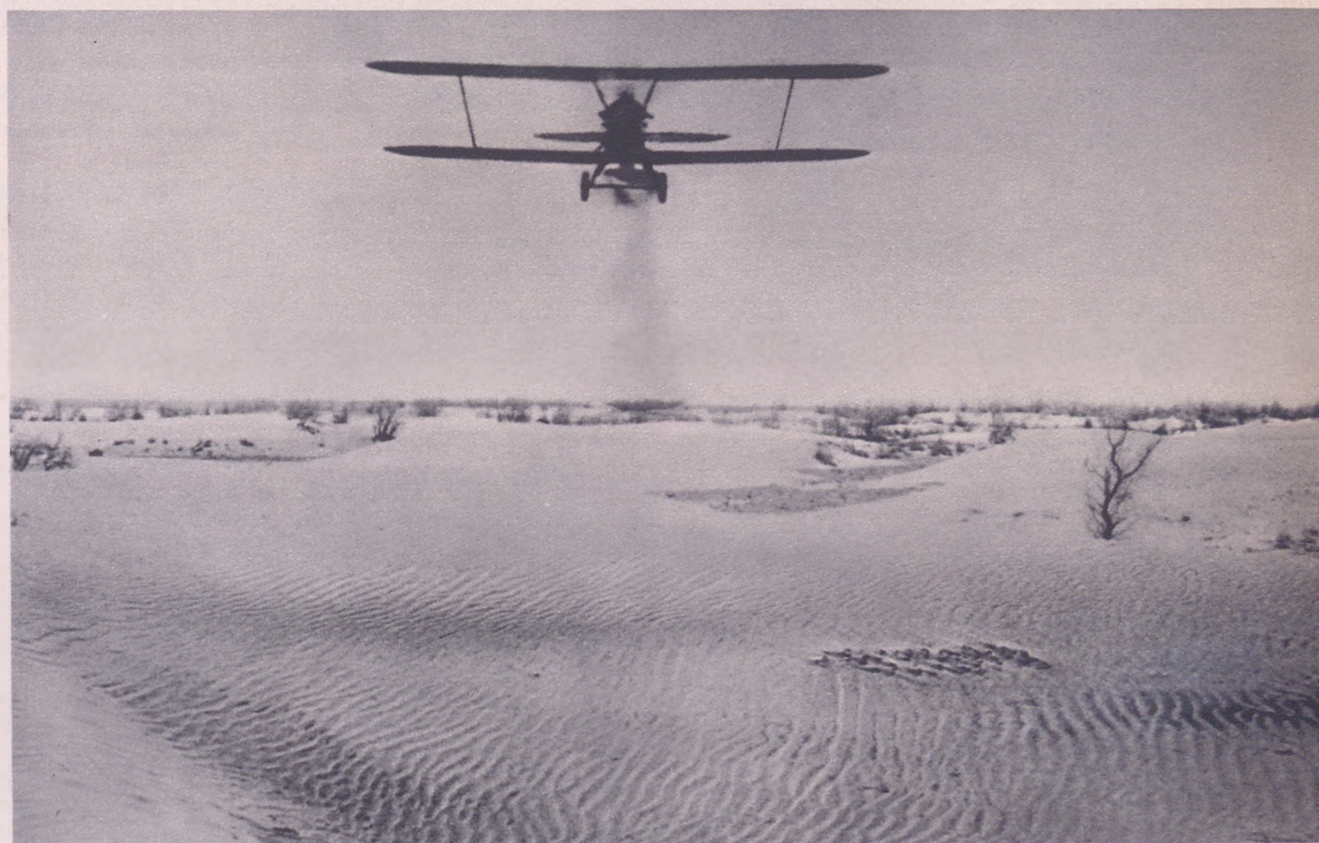
На верхнем снимке — аэродром в пустыне; семена саксаула перегружаются с верблюдов на самолет сельскохозяйственной авиации. На втором снимке — самолет на бреющем полете проносится над участком, подготовленным к засеву семенами черного саксаула. Обскриленные семена растения ровной полосой ложатся на песок. Такой сев в 50 раз производительнее ручного.
