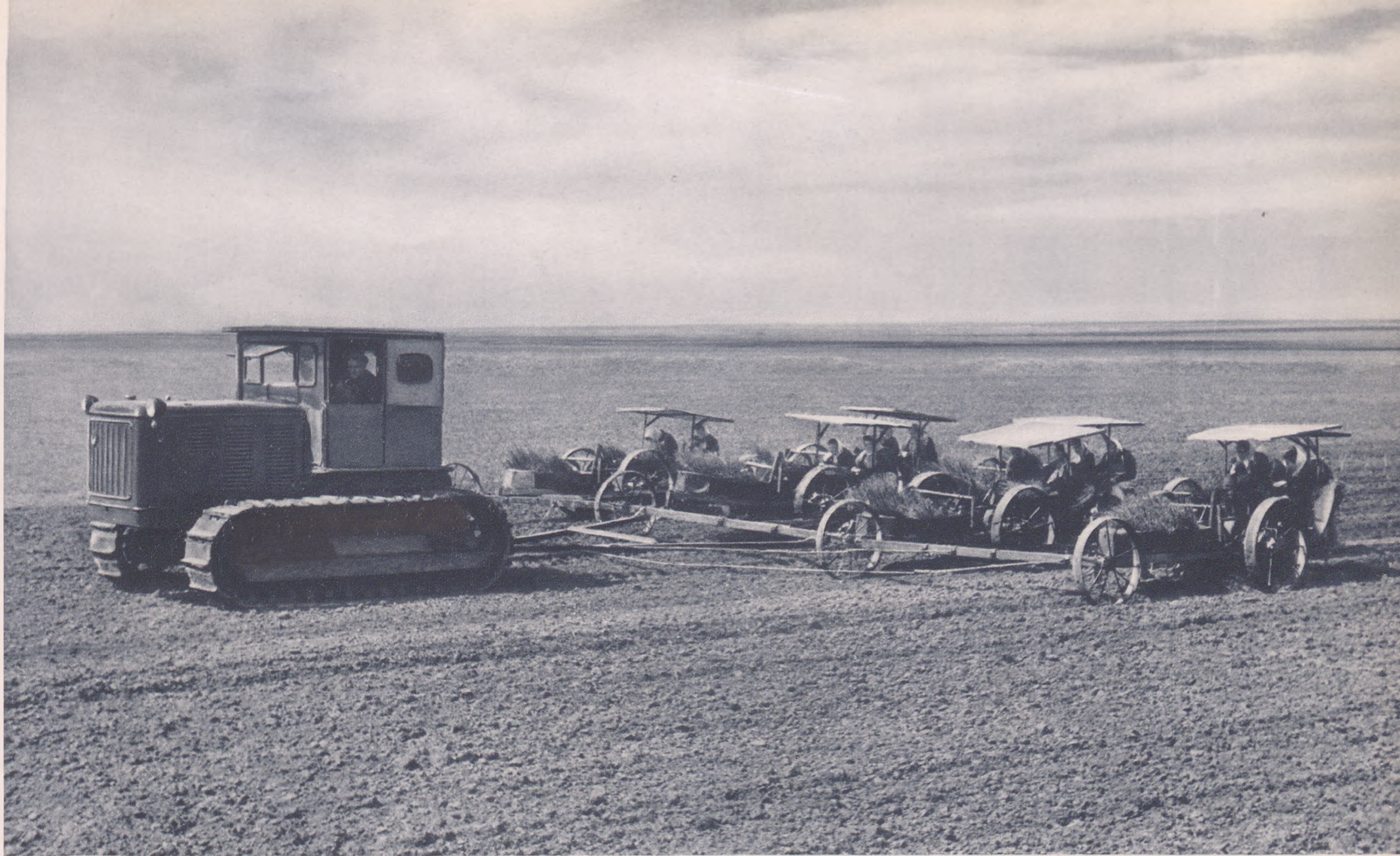
На участке Чугуевской лесозащитной станции досрочно закончена посадка государственной лесной полосы Белгород—Азовское море. На снимке — сцеп из семи лесопосадочных машин „СЛН-I“ конструкции советского инженера А. Недашковского заканчивает посадку сеянцев.
