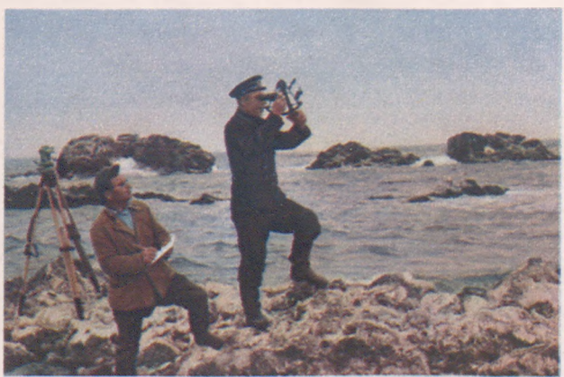
Старший инженер гидрограф-геодезист А. Куценко (справа) и его помощник А. Родин определяют место расположения будущей морской скважины. На нижнем снимке — одна из каменных гряд в районе Острова семи кораблей.
