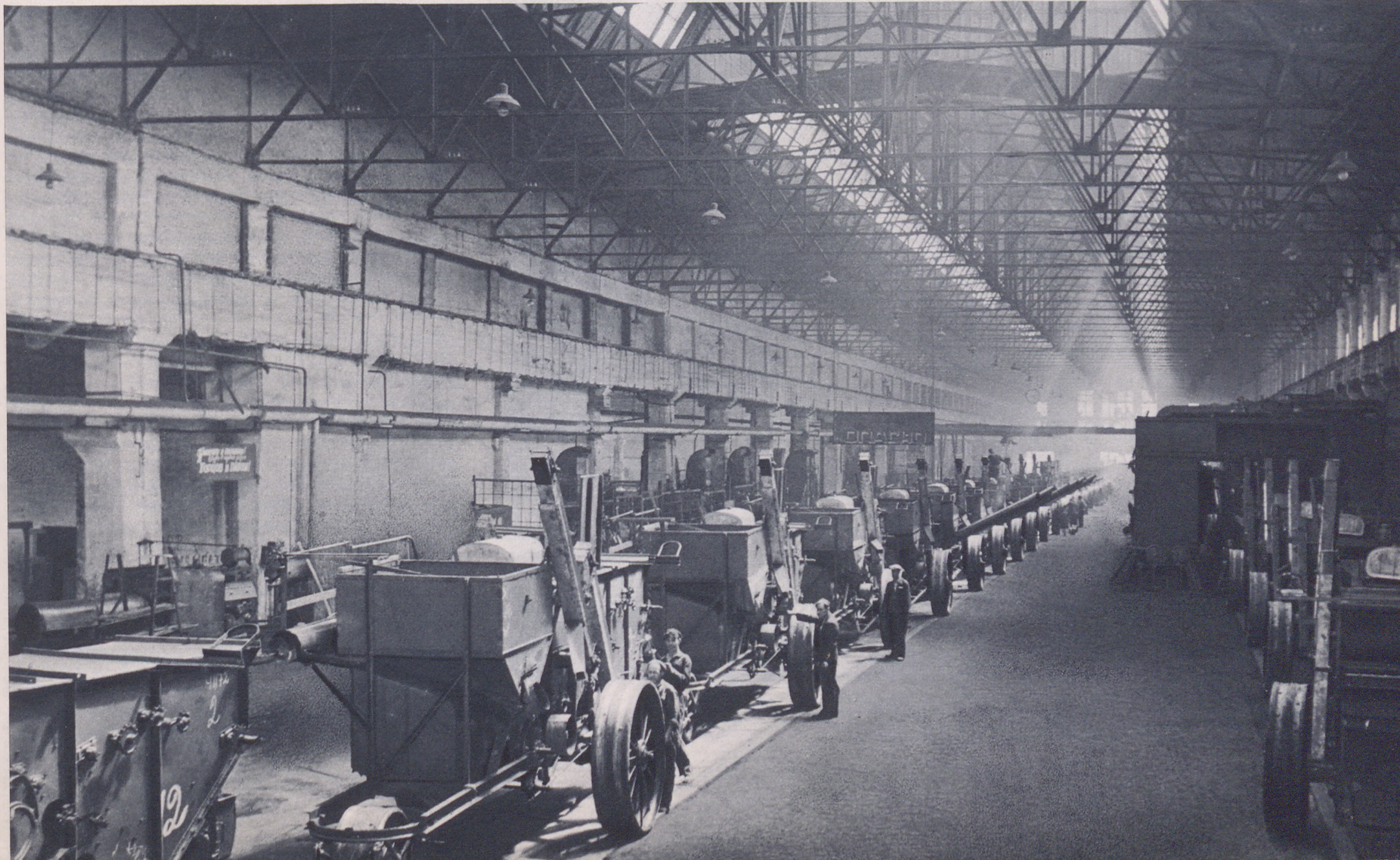
Ростовский завод сельскохозяйственных машин. Сборка комбайнов на главном конвейере.
