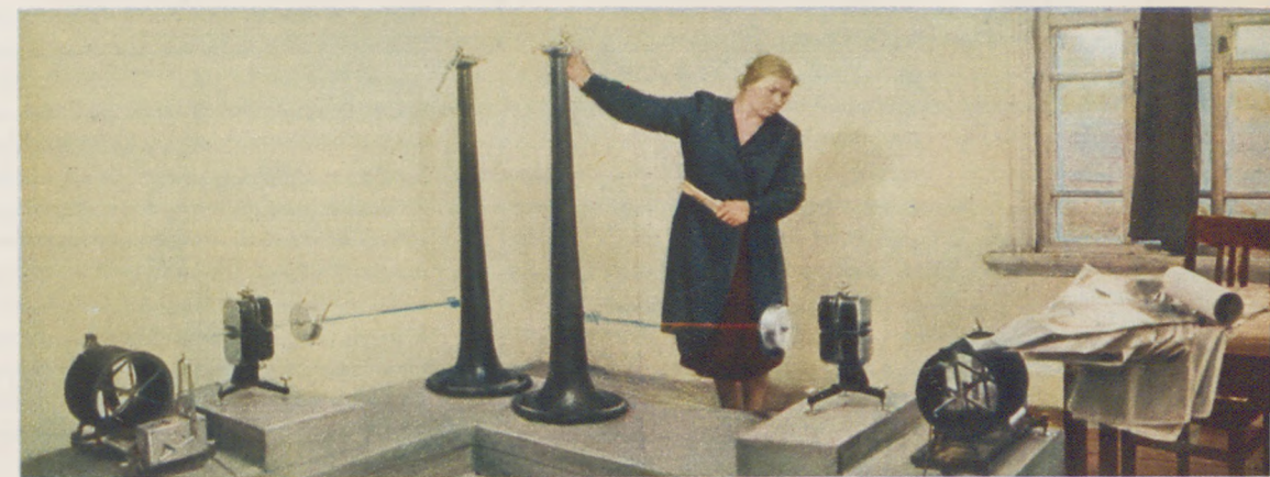
Малейшие колебания почвы, вызванные извержением вулкана или землетрясением, будут записаны сейсмографами вулканологической станции. Лаборантка-сейсмолог В. П. Энман следит за показаниями чувствительных приборов.
