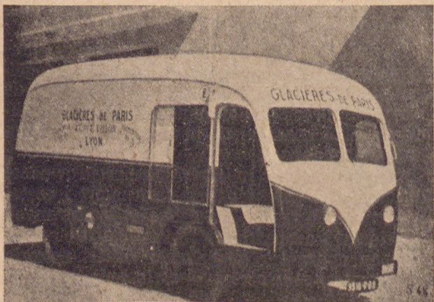
Samochód ciężarowy marki „Sovel“ — nośność 3 t. (akumulatorowy)
