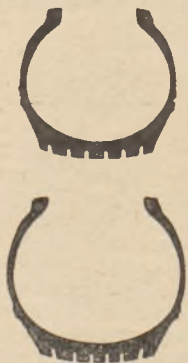
Na zdjęciu z lewej — opona starej konstrukcji; z prawej — opona nowej konstrukcji.
