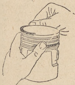
Rys. 12 Sposoby sprawdzenia, w którą stronę wygięty jest pierścień Cordsa.
