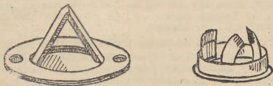
RYS. 1 (z lewej) — wkładka stosowana w samochodzie Willys; RYS. 2 (z prawej) — wkładka podgaźnikowa samochodu Bugatti.
