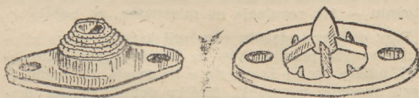
RYS. 3 (z lewej) — wkładka typowa „Vokes”; RYS. 4 (z prawej) — wkładka skrzydełkowa.
