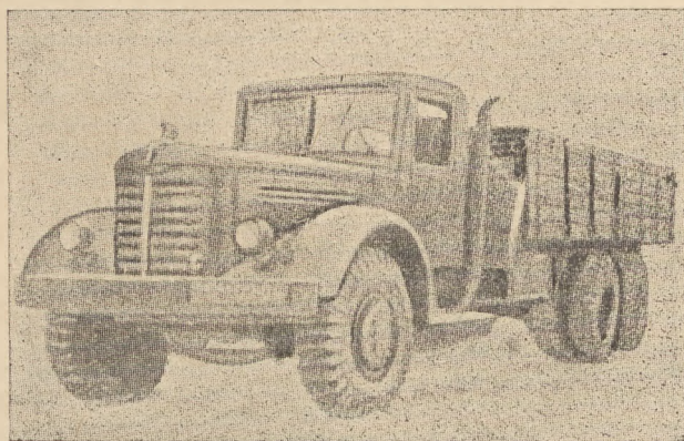
Rys. 16. Sześciokołowa ciężarówka JAZ-210 o ładowności 12 t. produkcji Jarosławskich Zakładów Samochodowych — jedna z odmian podstawowego typu 7-tonowej ciężarówki JAZ-200
