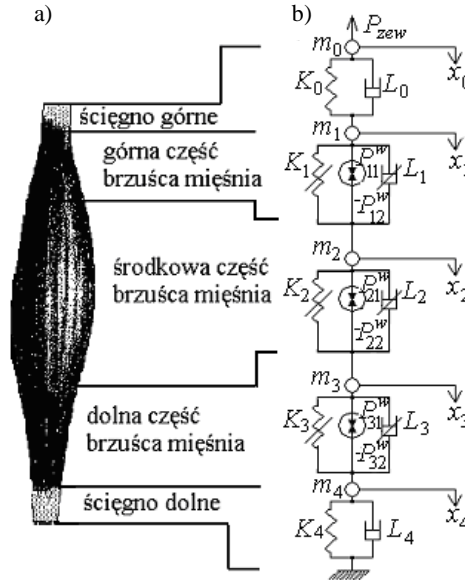
Rys. 3.11. Model mięśnia: a) podział mięśnia na fragmenty, b) reologiczny model mięśnia o nierównoważonych siłach wewnętrznych
