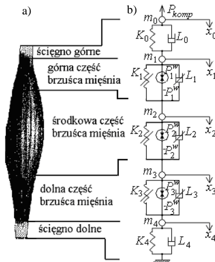
Rys. 3.14. Model mięśnia: a) podział mięśnia na fragmenty, b) reologiczny model mięśnia w czasie skurczu izometrycznego z uwzględnieniem działania siły kompensacyjnej P_{komp}
