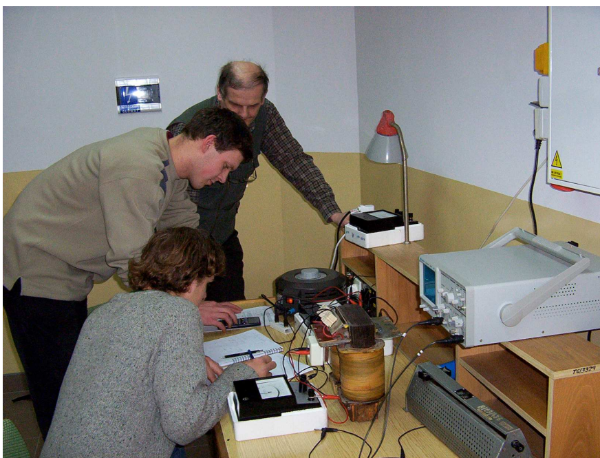
Badanie transformatora w czasie zajęć laboratoryjnych
