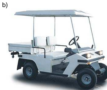
Stanowiska dydaktyczne: a) zespół napędowy sterowany cyfrowo z maszynami: indukcyjną, prądu stałego i z magnesami trwałymi; b) pojazd elektryczny typu Melex z komputerowym układem pomiarowo-rejestrującym
