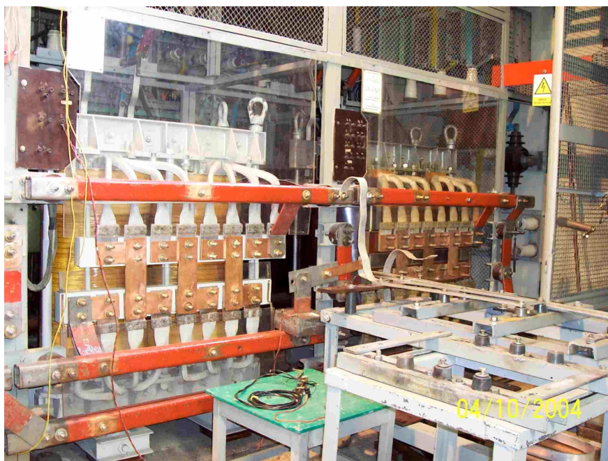
Stanowisko do badania efektów prądów zwarciowych i dużych prądów łączeniowych
