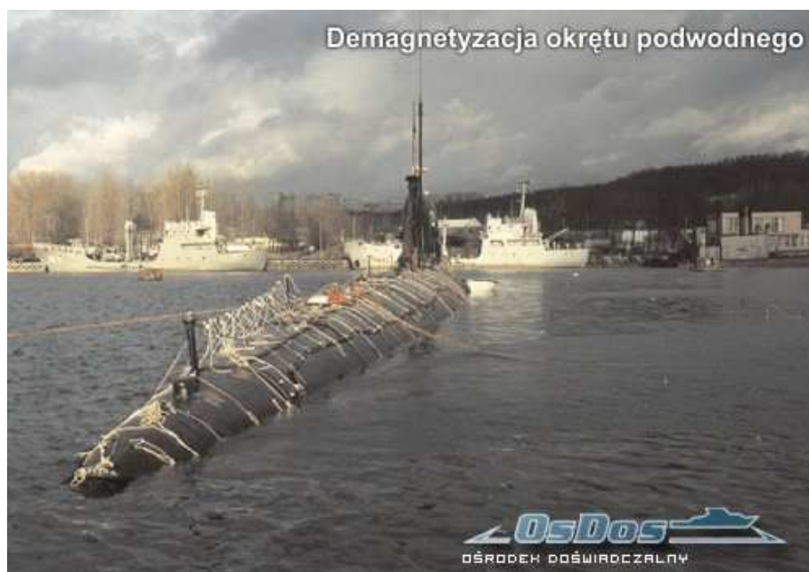
Okręt podwodny na poligonie demagnetyzacyjnym
