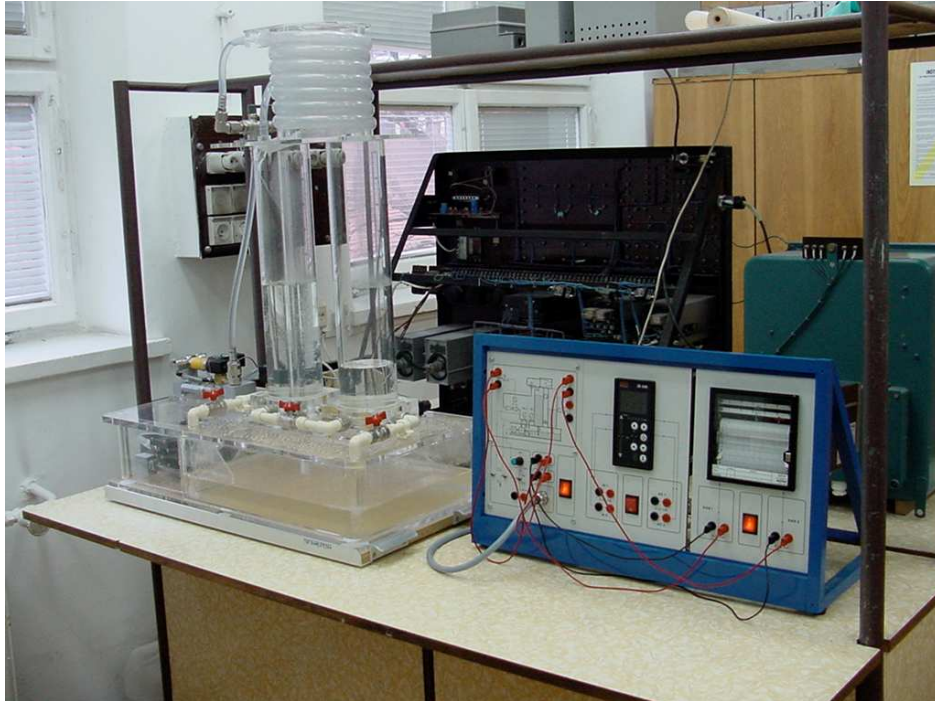
Stanowisko do badania układów regulacji poziomu wody z regulatorem cyfrowym EFTRONIK X
