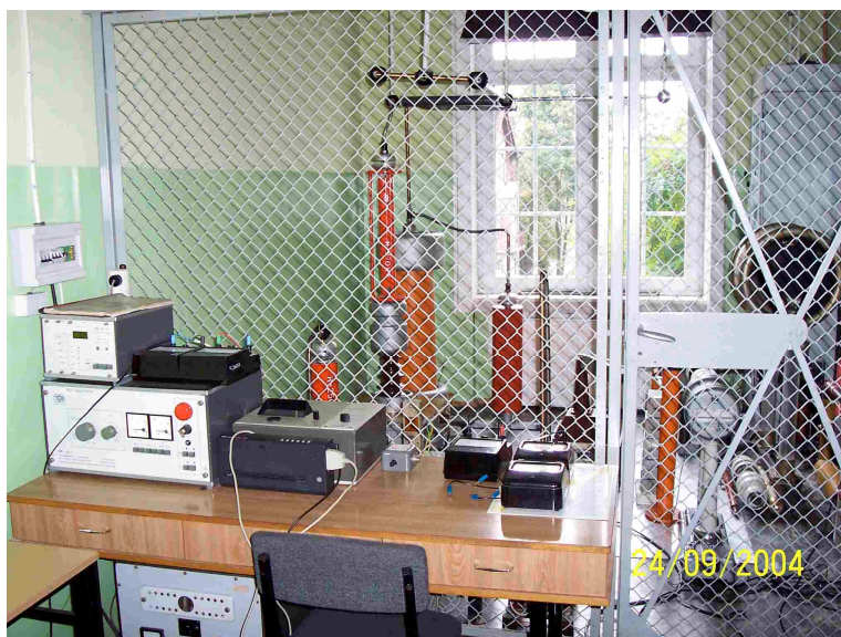
Stanowisko wysokiego napięcia przemiennego do demonstracji metod pomiarowych oraz prób wytrzymałości elektrycznej powietrza w różnych układach elektrod
