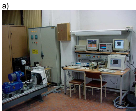
Stanowiska dydaktyczne: a) zespół napędowy sterowany cyfrowo z maszynami: indukcyjną, prądu stałego i z magnesami trwałymi; b) pojazd elektryczny typu Melex z komputerowym układem pomiarowo-rejestrującym
