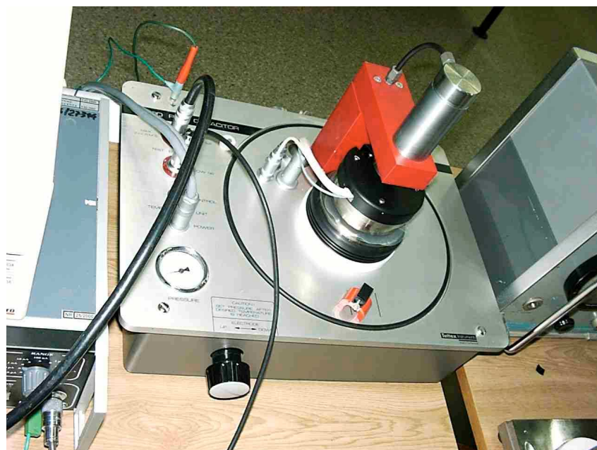
Stanowisko do pomiaru procesów ładowania izolacji polimerowej, w tym elektretów
