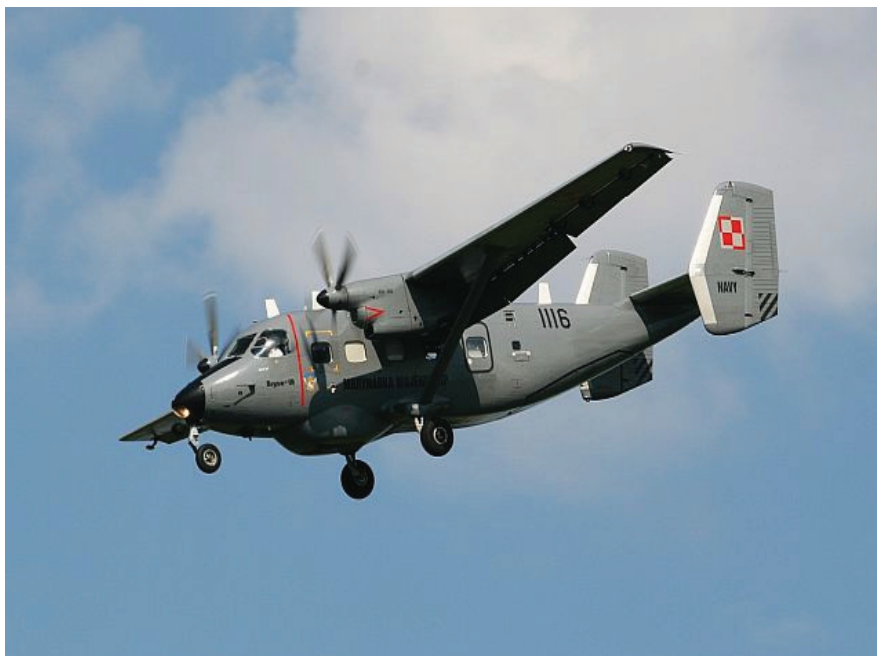
Samolot rozpoznawczy Bryza z magnetometrem w części ogonowej
