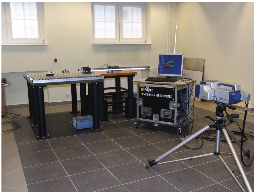
Stanowisko laserowych pomiarów wibracyjnych
