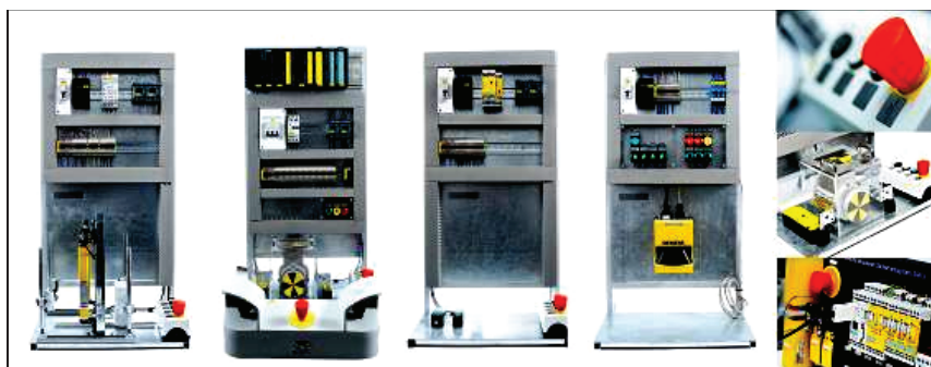
Stanowiska do badania przemysłowych układów automatyki zabezpieczeniowej
