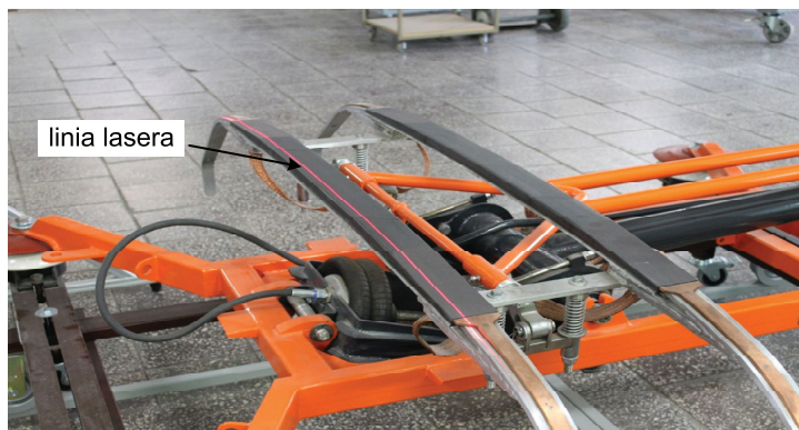
Stanowisko laboratoryjne wizyjnej inspekcji nakładek stykowych WINS – nakładka ślizgacza podczas skanowania 3D (widoczna czerwona linia lasera)
