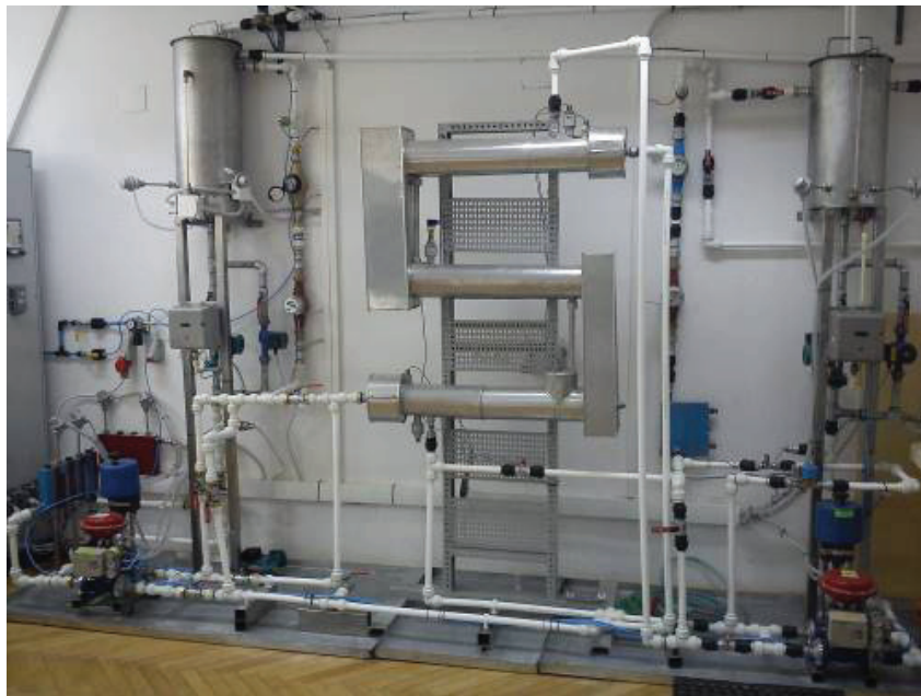
Zmodernizowane stanowisko laboratoryjne z wymiennikiem ciepła do badań elektrycznych i pneumatycznych układów sterowania i regulacji
