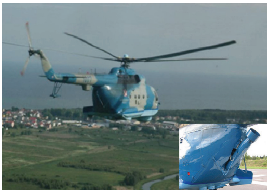
Śmigłowiec Mi-14P z systemem magnetometrycznym o kr. MNISZKA
