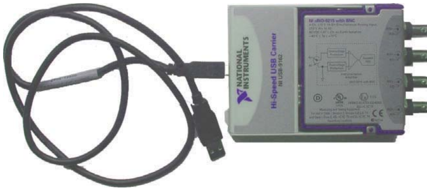
Rys. 9.2. Przykładowy moduł akwizycji z interfejsem USB
