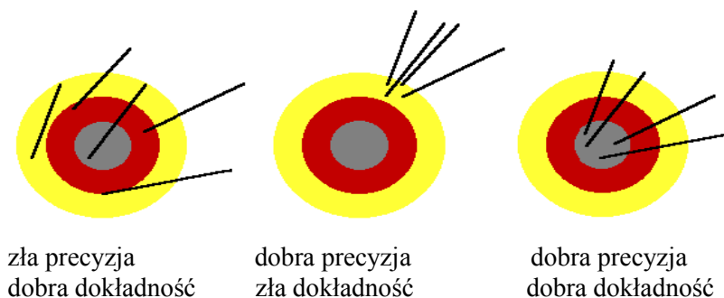
Ryc. 1.6. Zależność pomiędzy precyzją a dokładnością metody analitycznej
