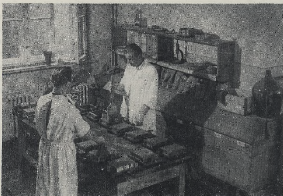
Laboratorium Katedry Żelbetnictwa. Ćwiczenia studentów — wykonywanie ciał próbnych beleczek betonowych
