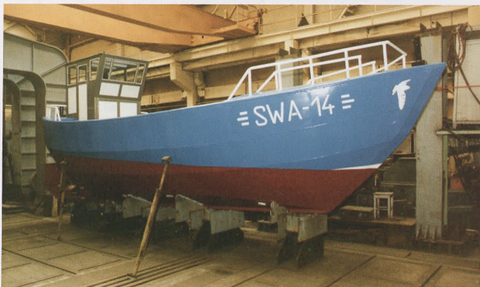
Zatokowy, stalowy kuter rybacki zbudowany w Katedrze Technologii Okrętów - 1995 r.
