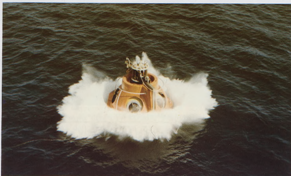
Wodowanie kapsuły ratowniczej opracowanej w Katedrze Technologii Okrętów kierowanej przez prof. Jerzego Doerffera
