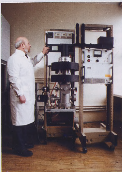
Stanowisko niskociśnieniowej syntezy cienkich warstw diamentowych, w procesie PA (ECR) CVD
