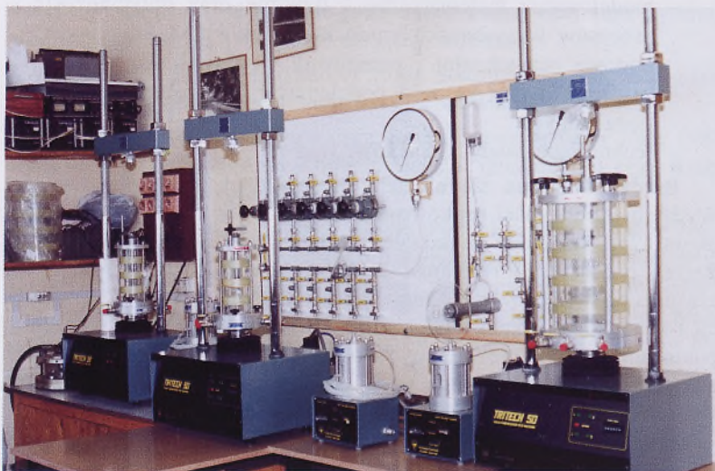
Laboratorium Geotechniki - aparatura do badań trójosiowego ściskania próbek gruntu
