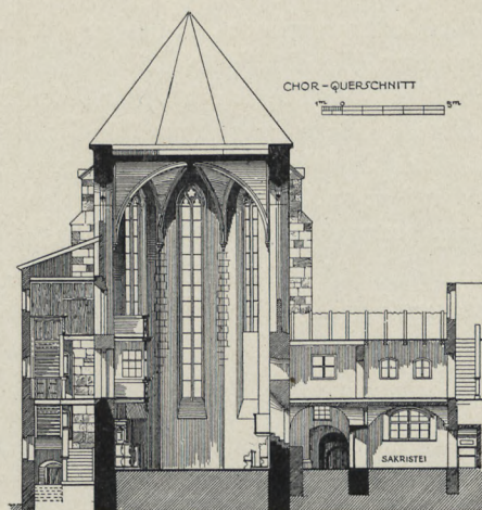
225. St. Oswald, Chorquerschnitt. (S. 290.)
