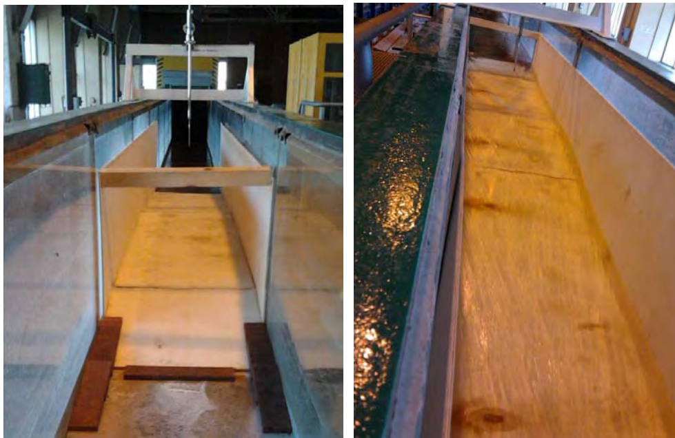
Fot. 6.4. Zdjęcie kanału o zmiennym spadku dna: po lewej konstrukcja stanowiska, po prawej stanowisko w trakcie działania.
