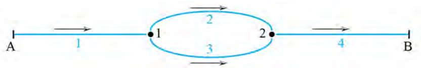
Rys. 5.3. Schemat sieci kanałów opływ wyspy (strzałki oznaczają dodatni kierunek przepływu).
