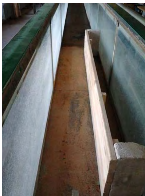
Fot. 6.3. Zdjęcie kanału o uchylno z przeszkodą – nagłe zwężenia kanału.
