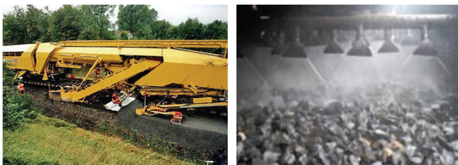
Rys. 10.37. Widok maszyny PM 200-2R do wymiany nawierzchni (z lewej). Widok płuczki ciśnieniowej czyszczącej podsypkę (z prawej) [6]
