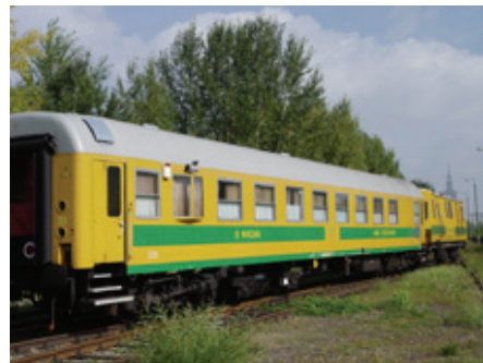
Rys. 10.17. Defektoskopia szynowa: od lewej defektoskop ręczny i wagon defektoskopowy [5]
