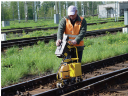
Rys. 10.17. Defektoskopia szynowa: od lewej defektoskop ręczny i wagon defektoskopowy [5]
