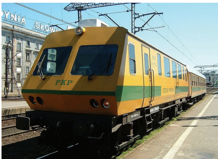
Rys. 10.4. Drezyna pomiarowa EM120
