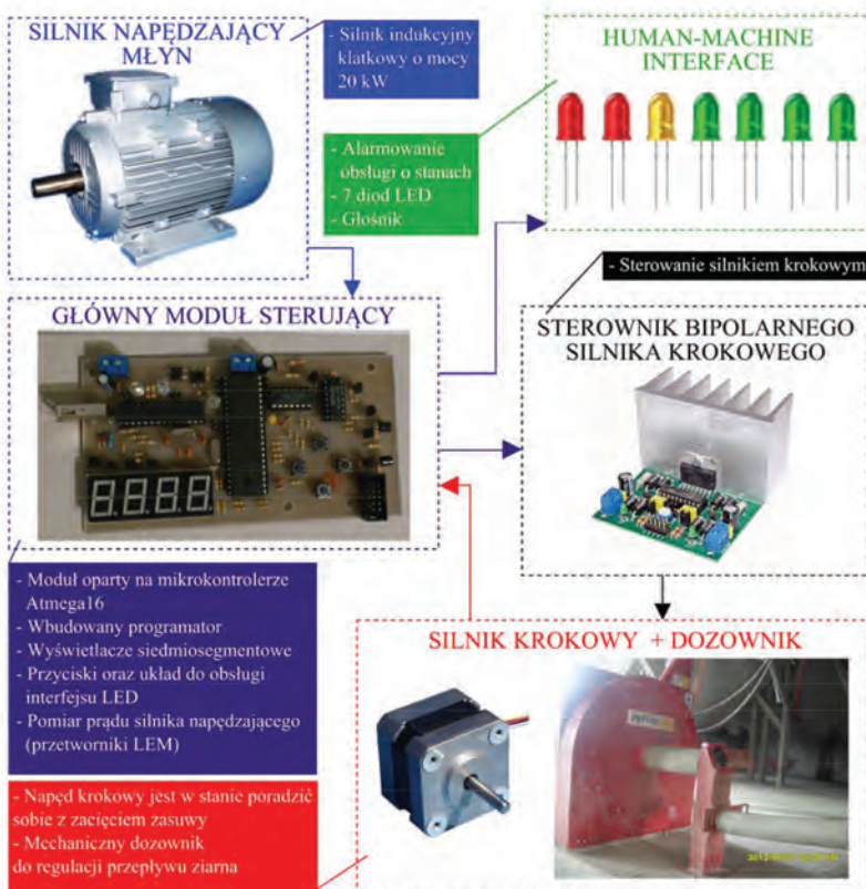
Rys. 1. Schemat ideowy układu sterownika dozownika
