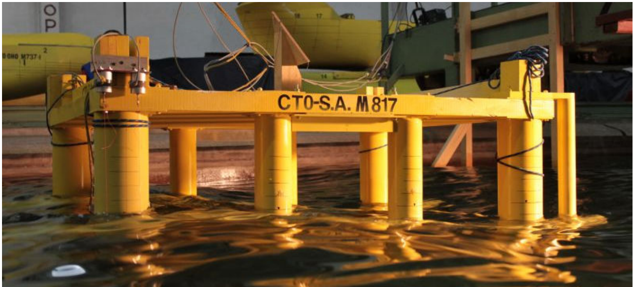
Fot. 2 Model platformy półzanurzalnej podczas badań modelowych,
