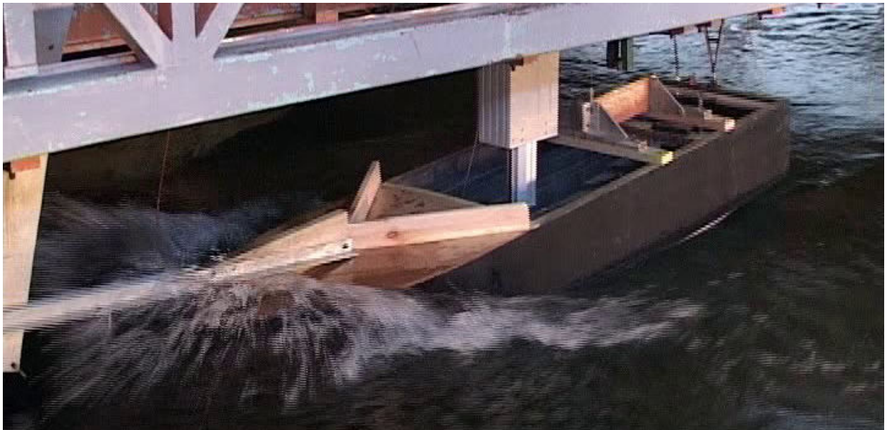
Fot. 1 Model statku rybackiego podczas prób
