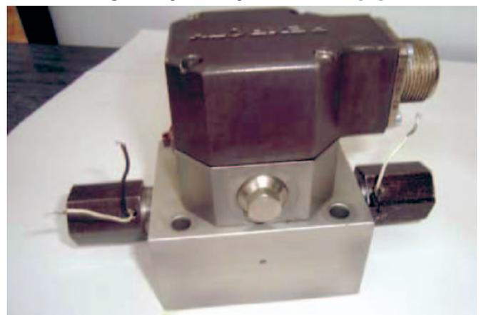
Fig. 23. Servovalve 4WS2EM10 - 45/20B2T315Z8EM [18]
