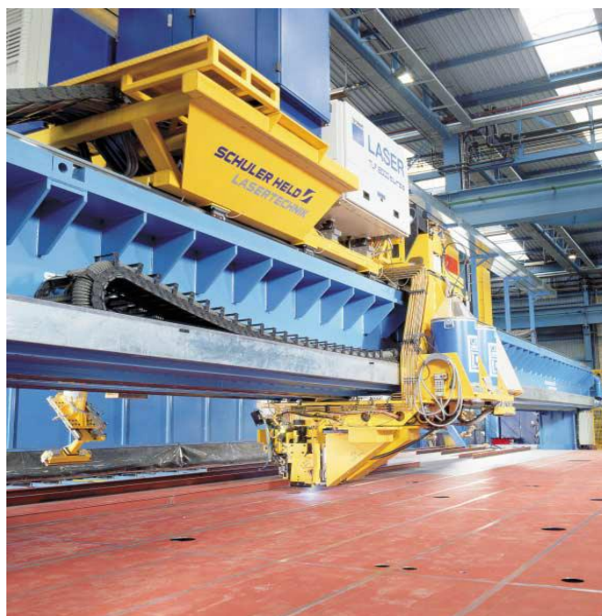
Rys.2.14 Stanowisko do spawania Stalowych paneli typu sandwich laserem 14kW [33]
