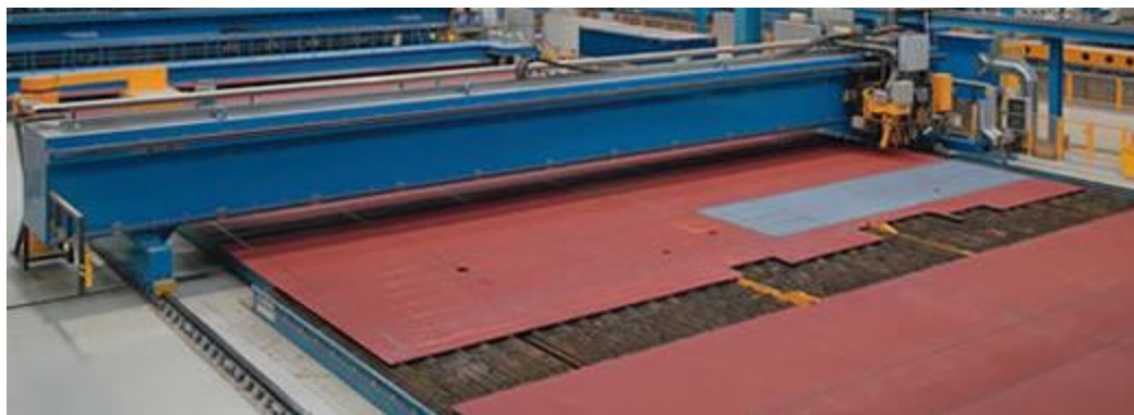
Rys.2.12 Stanowisko do łączenia blach w płyty z zintegrowaną frezarką do przygotowania krawędzi [33]
