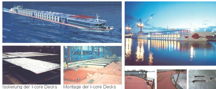
Rys.2.15 Pokłady statków rzecznych wykonanych ze stalowych paneli typu sandwich [45], [46]
