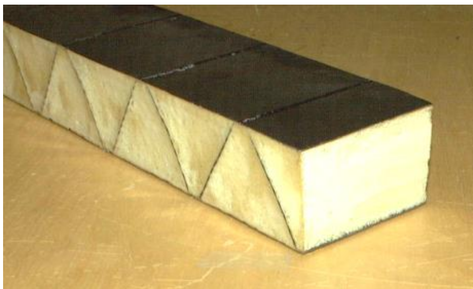
Rys.2.5 Konstrukcja stalowego panelu typu V-core z wypełnieniem [17]
