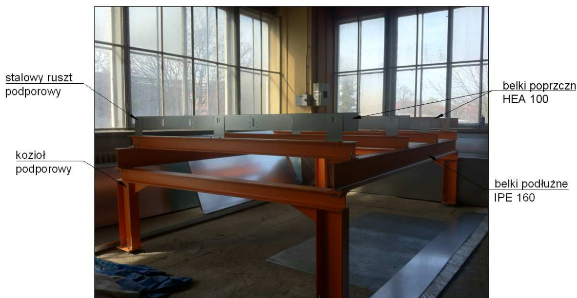
Rys. 29. Zdjęcie stanowiska badawczego z opisanymi elementami składowymi. Fot. P. Lewandowski.
