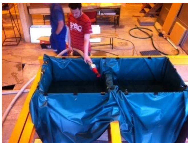
Rys. 40. Napełnianie komór wanny wodą w przypadku obciążenia symulującego ssanie wiatru, na fotografii również widoczny system dostarczania wody do stanowiska. Fot. P. Lewandowski.
