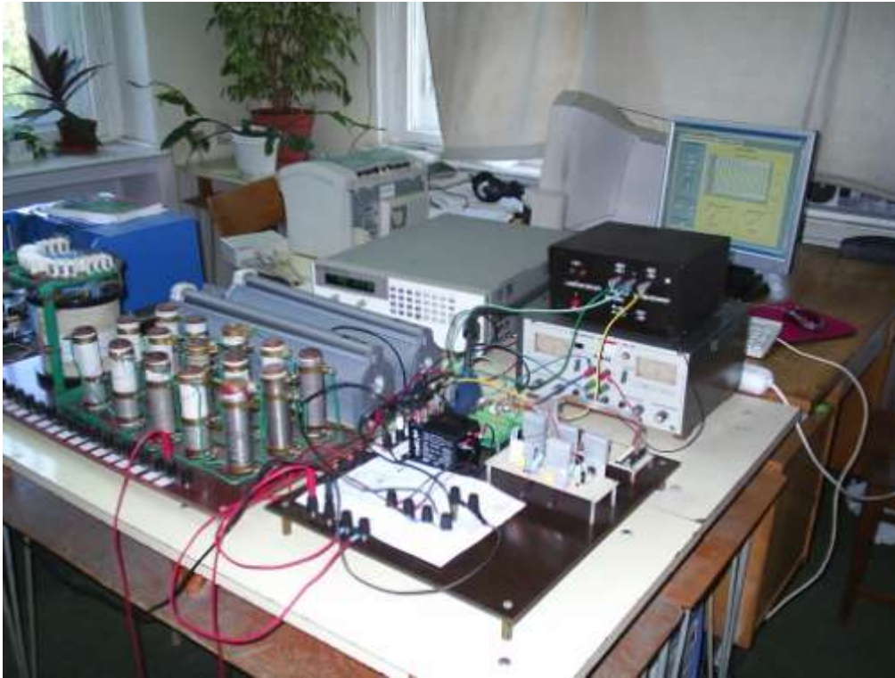
Rys. 6.24. Wygląd stanowiska laboratoryjnego z fizycznym modelem miernika i układu do wzorcowania
