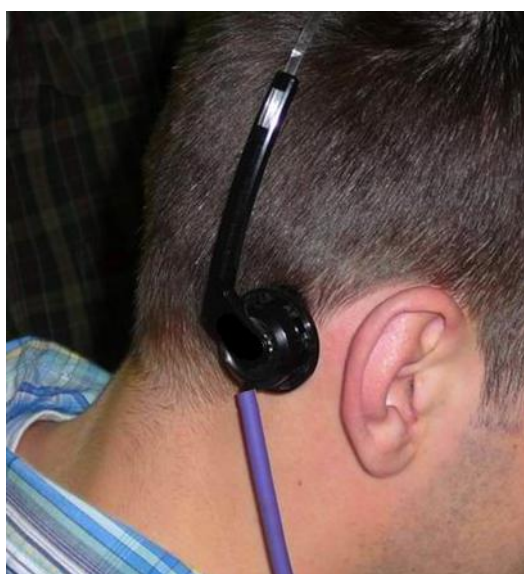
Rysunek 5.5. Ultradźwiękowa słuchawka kostna umiejscowiona na wyrostku sutkowatym
