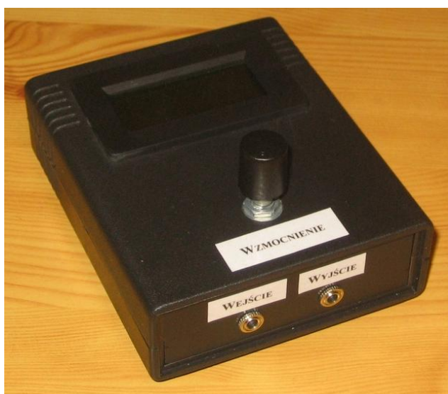
Rysunek 5.2. Widok zewnętrzny wzmacniacza ultradźwiękowego stosowanego w badaniach, na pierwszym planie widoczne wejście i wyjście wzmacniacza oraz potencjometr służący do zmiany wzmocnienia, w głębi widoczny wyświetlacz woltomierza
