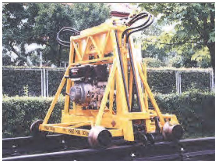
Rys. 4.11. Nasuwarka toru NHC [84]
