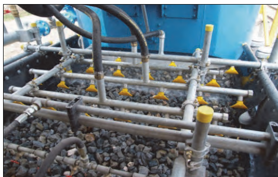
Rys. 6.48. System płukania podsypki na oczyszczarce RM96-800W [68]
