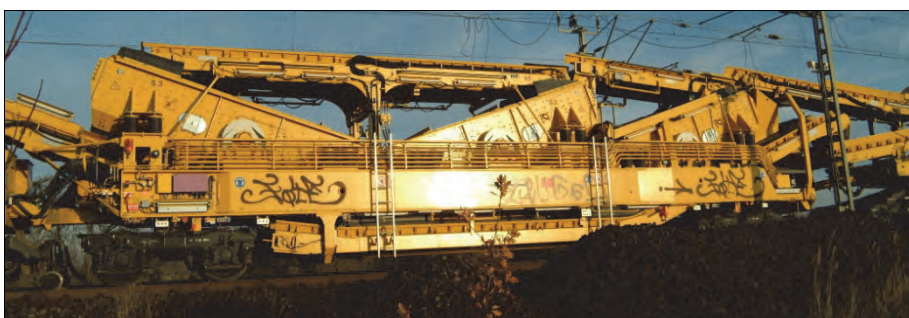
Rys. 6.37. Oczyszczarka tucznia RM800 Super 3S – widoczne trzy przesiewacze [68]
