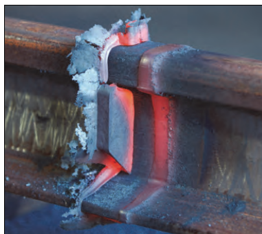
Rys. 7.2. Wyplywka obcięta przez noże zgrzewarki [76]
