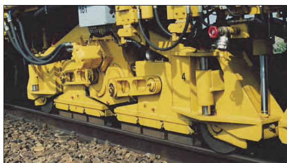
Rys. 8.20. Moduł szlifujący maszyny GWM250 [68]
