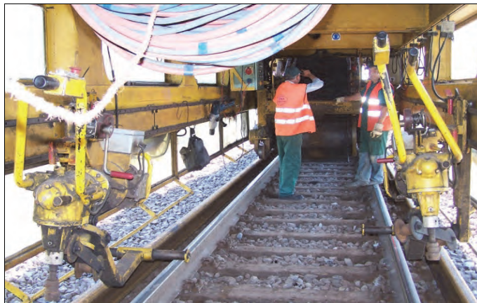
Rys. 9.56. Zakrętkarki obsługiwane przez dwóch operatorów w zespole PUN. W głębi separator magnetyczny (J. Zariczny)
