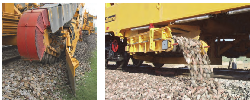
Rys. 6.80. Łańcuch wybierakowy i zsypanie podsypki oczyszczarki FRM802 [68]
