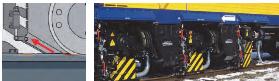
Rys. 8.37. System zasysania wiórów i zanieczyszczeń frezarki SF03-FFS [51, 65]
