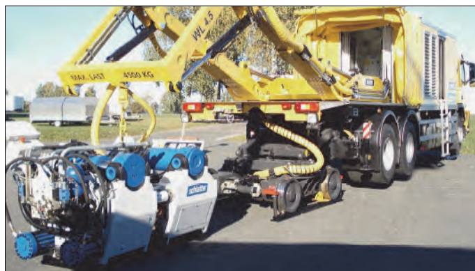
Rys. 7.5. Pojazd dwudrogowy z głowicą zgrzewającą AMS100 [76]
