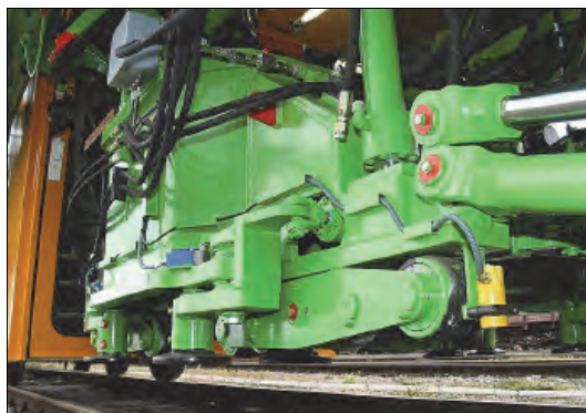
Rys. 8.48. Moduł strugający maszyny SBM250 [68]
