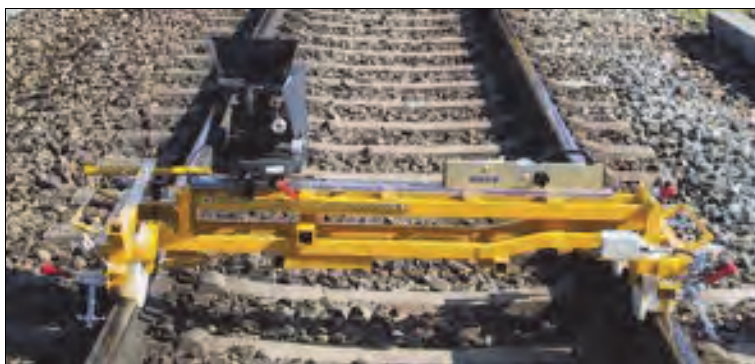
Rys. 5.41. Wózek pomiarowy z nadajnikiem laserowym [46]
