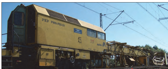
Rys. 9.74. Kabina z pomieszczeniem silnikowym członu WF w zespole PUN (J. Zariczny)
