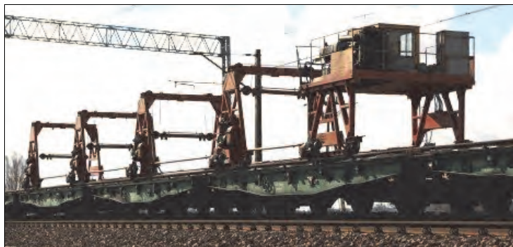
Rys. 9.24. Przejazd SBT-5 po torze podsuwnicowym na wagonach [69]
