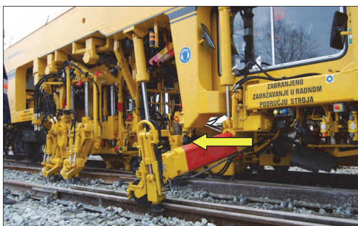
Rys. 5.20. Układ podnoszący w podbijarkach UNIMAT 08-475/4S [68]
