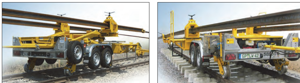
Rys. 9.17. Wyładunek szyn przy użyciu urządzenia EMD [62]
