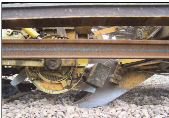
Rys. 9.63. Urządzenie do wyjmowania podkładów z toru w zespole PUN (J. Zariczny)
