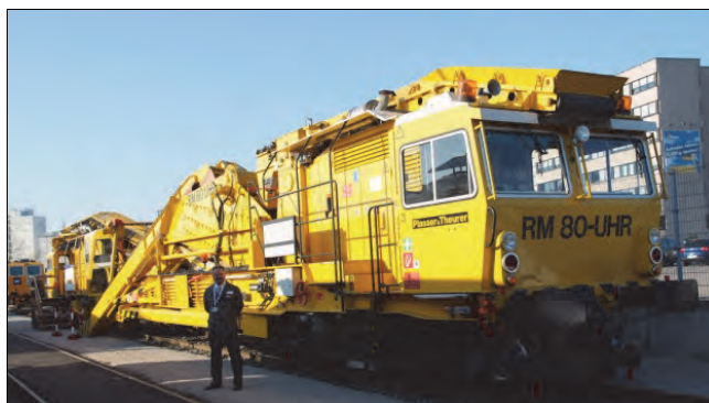
Rys. 6.47. Przenośniki taśmowe nowej podsypki na oczyszczarce RM80 UHR-N [68]
