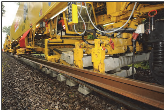
Rys. 9.88. Urządzenie do układania nowych szyn w maszynie SUM-Q3 [68]
