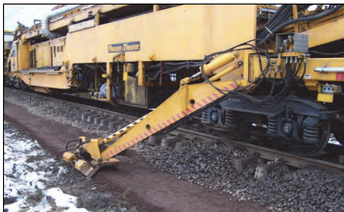
Rys. 11.37. Dwie dodatkowe płyty wibracyjne w maszynie AHM 800R (J. Zariczny)
