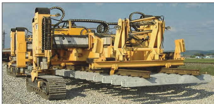
Rys. 9.36. Transport nowego przęsła torowego układarką DESEC TL [56]
