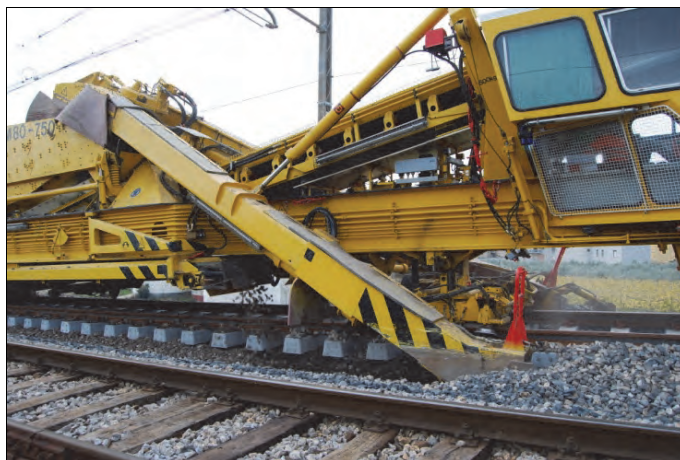
Rys. 6.4. Zespół wybierania i transportu zanieczyszczonej podsypki [68]
