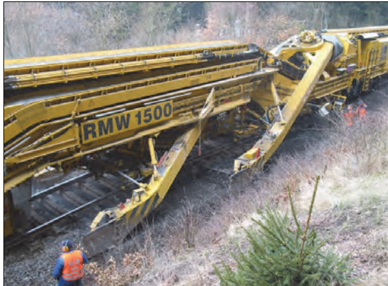
Rys. 6.38. Oczyszczarka RMW 1500 – widoczne dwa łańcuchy wybierakowe [68]
