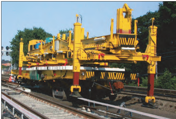
Rys. 10.36. Maszyna WM-40/PK do wymiany rozjazdów [68]
