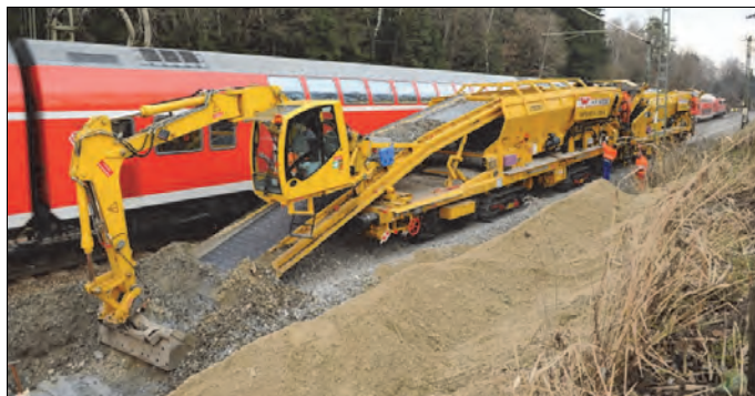
Rys. 6.71. Platforma załadunkowa z nadwoziem koparki [68]
