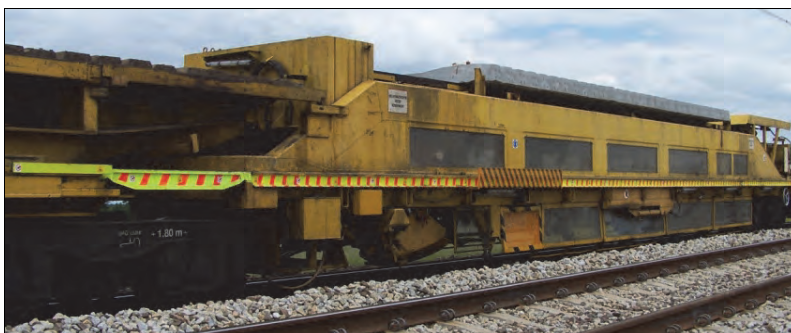
Rys. 9.65. Platforma pośredniego składowania podkładów starych (z lewej) i nowych w zespole PUN (J. Zariczny)
