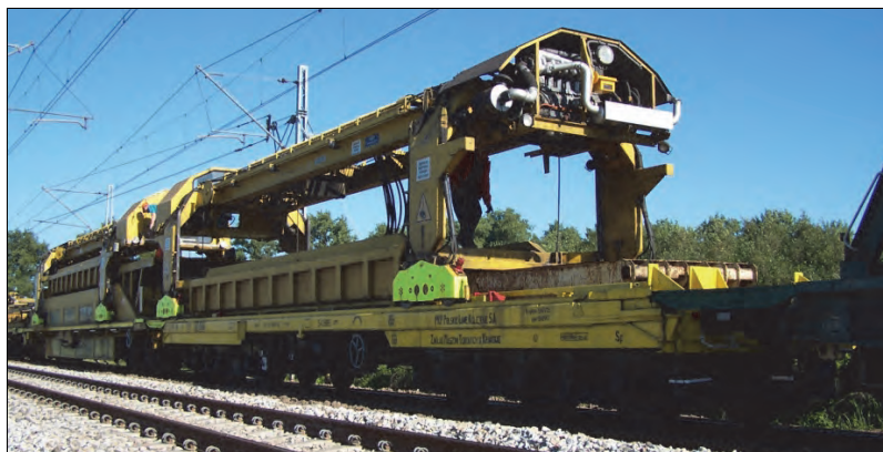
Rys. 9.53. Człony PKW (z lewej) i WES z suwnicami bramowymi zespołu PUN (J. Zariczny)
