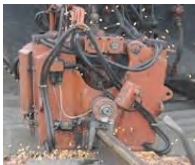
Rys. 7.3. Zgrzewarka PRSM-4 z głowicą zgrzewającą
