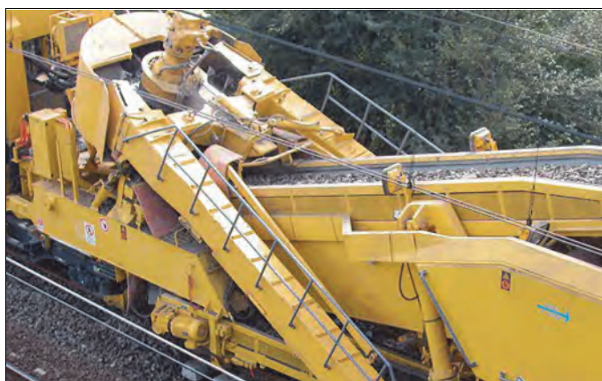
Rys. 6.5. Transport zanieczyszczonej podsypki na przesiewacz z wykorzystaniem przenośników taśmowych [67]
