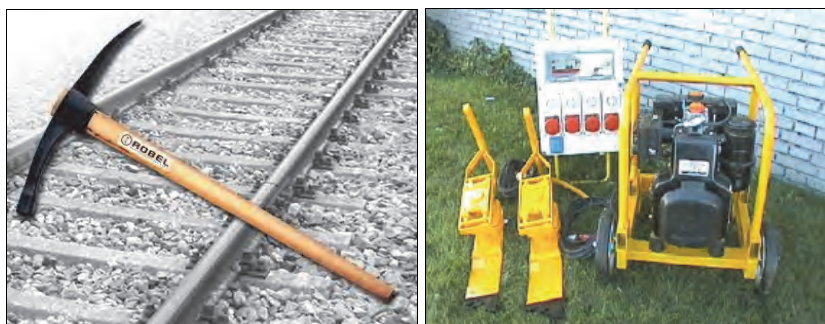
Rys. 3.34. Podbijak ręczny [74] i zespół podbijaków elektrowibracyjnych (G. Stencel)
