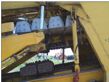
Rys. 9.64. Przenośniki łańcuchowe do podkładów starych (na dole) i nowych w zespole PUN (J. Zariczny)
