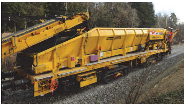
Rys. 6.68. Wagon MFS40-4ZW na podwoziu gąsienicowym [68]
