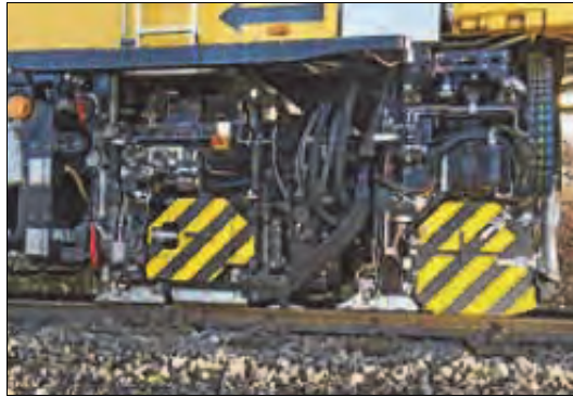
Rys. 8.44. Moduł frezujący i szlifujący maszyny SF02-FS Track [65]
