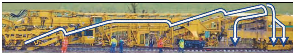
Rys. 9.78. Schemat transportu podsypki maszyną P95T [67]
