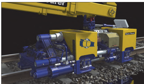
Rys. 7.13. Głowica zgrzewająca maszyny APT1500 [68]
