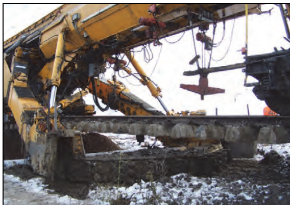
Rys. 11.31. Budowa AHM 800R: drugi łańcuch wybierakowy (J. Zariczny)
