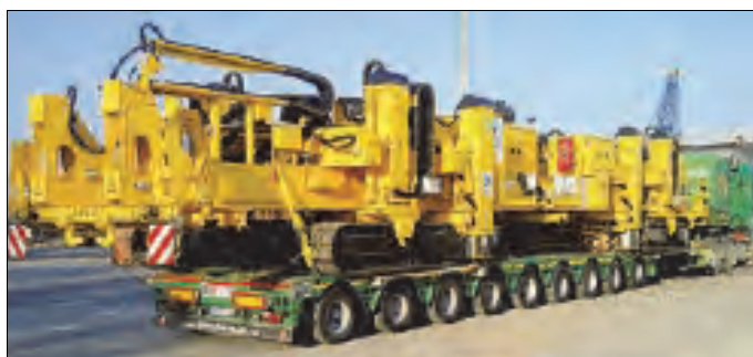
Rys. 9.38. Transport układarki DESEC TL na przyczepie niskopodłogowej [64]
