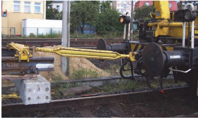
Rys. 10.22. Połączenie sprzęgiem rozjazdu z wózkiem motorowym przy zastosowaniu urządzenia UWR (J. Zariczny)
