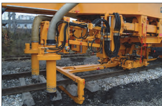
Rys. 6.53. Maszyna VM250 JUMBO – system zasysania tucznia [68]
