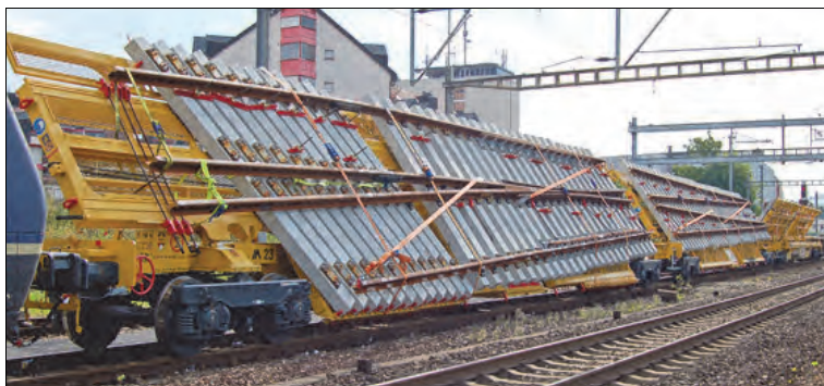
Rys. 10.6. Rozjazd zwyczajny w położeniu transportowym na wagonie WTM firmy Matisa [67]
