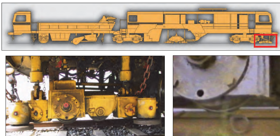
Rys. 8.54. Zespół usuwania spływów i zadziorów z główki szyny strugarki SBM250 [68]
