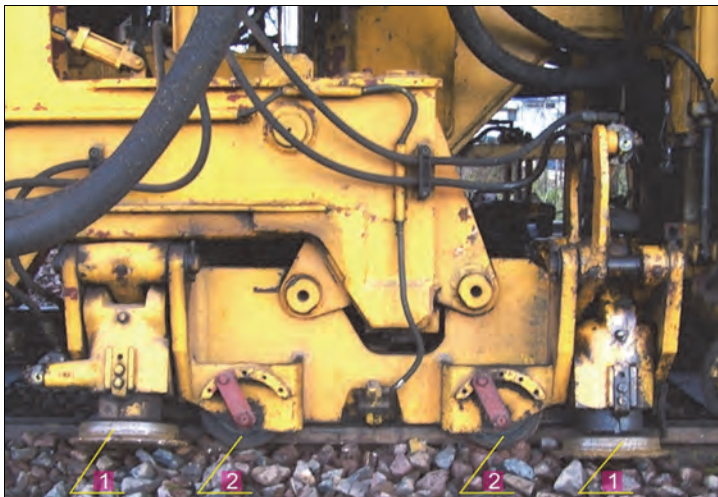
Rys. 5.16. Zespół nasuwająco-podnoszący w podbijańce 09-32 CSM (J. Zariczny): 1 – kleszcze talerzowe, 2 – rolki nasuwające
