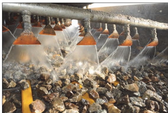
Rys. 11.48. System mycia podsypki tłuczniowej w maszynie PM200-2R [48]
