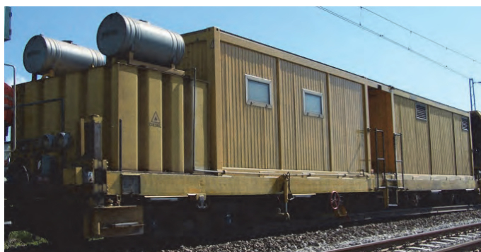
Rys. 9.76. Człon WMM w zespole PUN – z lewej zgarniacze podsypki (J. Zariczny)
