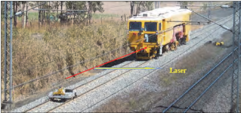
Rys. 5.38. Laserowy system prowadzenia podbijarki [6]
