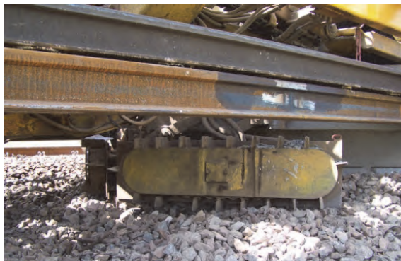
Rys. 9.67. Dwa zgarniacze podsypki w zespole PUN (J. Zariczny)
