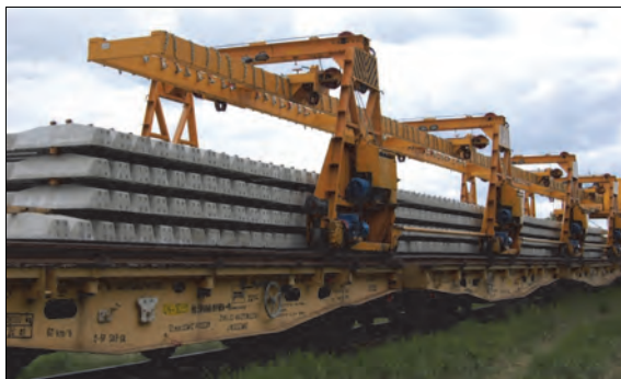
Rys. 9.40. Suwnice SBT-5 poruszające się po wagonach platformach [70]
