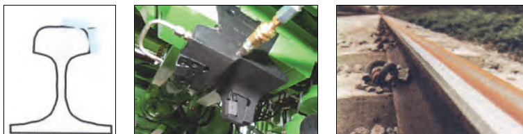
Rys. 8.50. Obróbka krawędzi tocznej główki szyny – kąt 22,5^\circ i 67,5^\circ [68]
