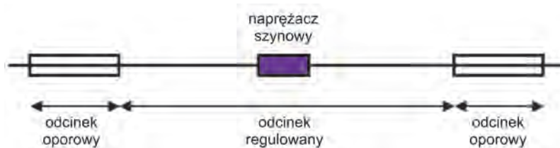
Rys. 4.34. Schemat odcinków toru regulowanego za pomocą naprężaczy szynowych
