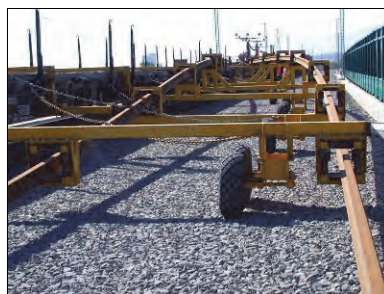
Rys. 9.13. Wózki do wyładunku szyn w systemie firmy NEW SOREMA FERROVIARIA [78]
