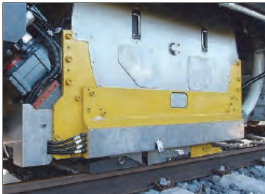
Rys. 8.58. Główny zespół roboczy maszyny D-HOB 2500 [30]
