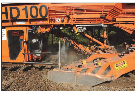
Rys. 6.46. System tłumienia pyłu zainstalowany na oczyszczarce RM900 HD100 [68]
