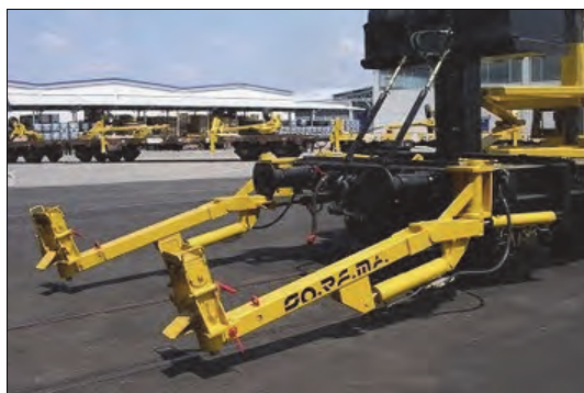
Rys. 9.11. Pochylnie do rozładunku szyn w systemie SRPR 13M [78]
