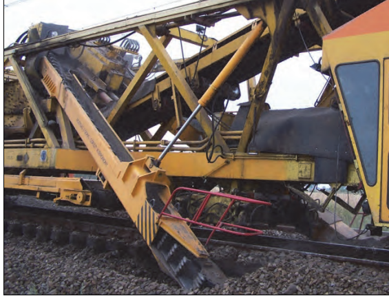
Rys. 6.23. Oczyszczarka OT 800 – łańcuch wybierakowy (J. Zariczny)
