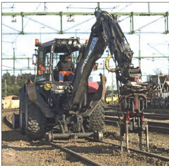
Rys. 4.3. Koparka dwudrogowa z zespołem podbijającym [73]
