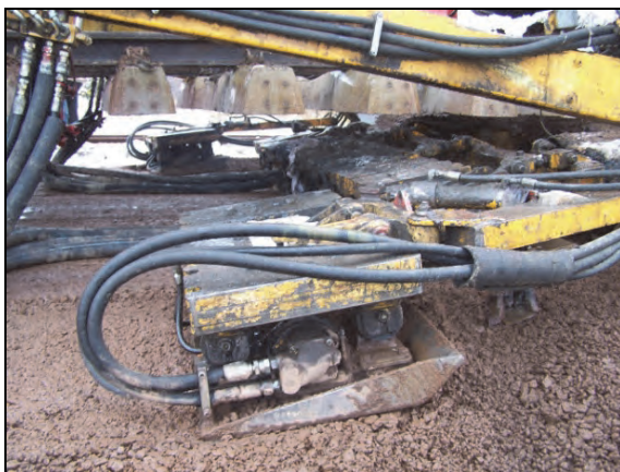
Rys. 11.35. Zespół sześciu płyt wibracyjnych w maszynie AHM 800R (J. Zariczny)
