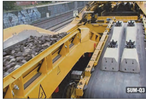
Rys. 9.87. Zespół wybierania podkładów (a); transport wybranej podsypki i nowych podkładów w maszynie SUM-Q3 (b) [68]
