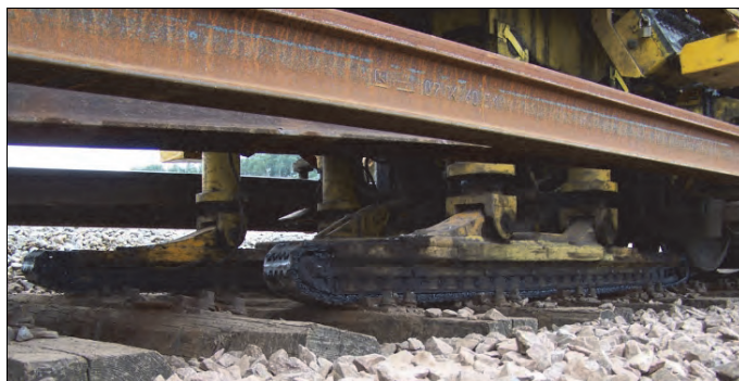
Rys. 9.60. Przednie sanie gąsienicowe zespołu PUN (J. Zariczny)
