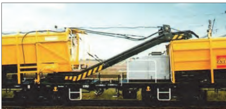
Rys. 6.59. Transport odsiewek pomiędzy wagonami TMS-40 [84]
