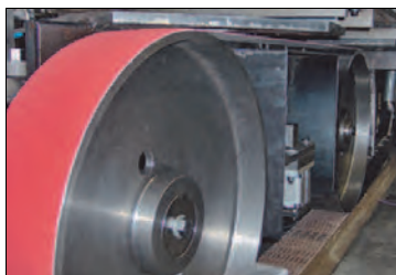
Rys. 8.24. Agregat szlifujący maszyny SM04 [126]
