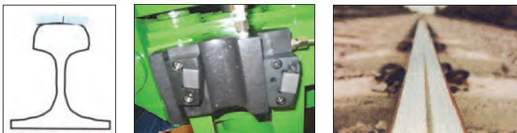
Rys. 8.52. Obróbka krawędzi tocznej główki szyny – kąt 5^\circ [68]
