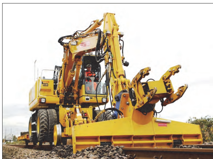
Rys. 4.13. Koparka dwudrogowa z osprzętem do wymiany podkładów typu SB60 firmy Rosenqvist & Pandrol [75]
