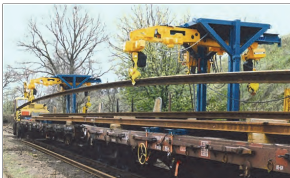
Rys. 9.18. System SHG do rozładunku szyn krótkich [82]
