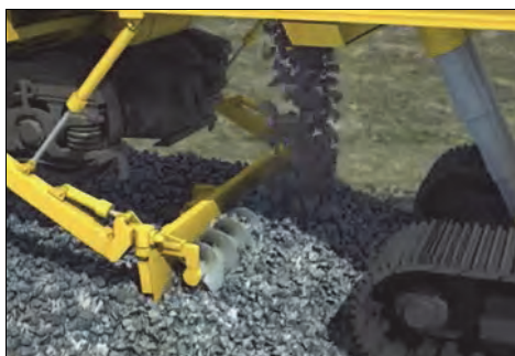
Rys. 6.45. Zsyep tylny i przenośnik w oczyszczarce ZRM350 [68]
