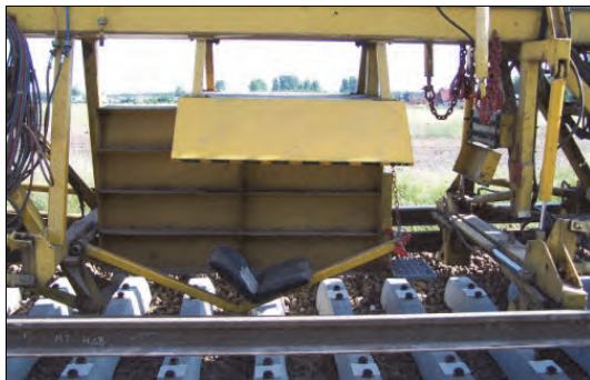
Rys. 9.72. Stanowisko do uzupełniania przekładek podszynowych w zespole PUN (J. Zariczny)
