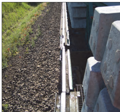
Rys. 9.52. Tor podsuwnicowy na wagonach platformach zespołu PUN (J. Zariczny)
