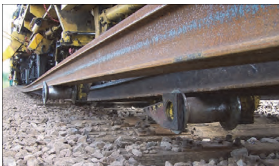
Rys. 9.62. Rolki do prowadzenia starych i nowych szyn w zespole PUN (J. Zariczny)
