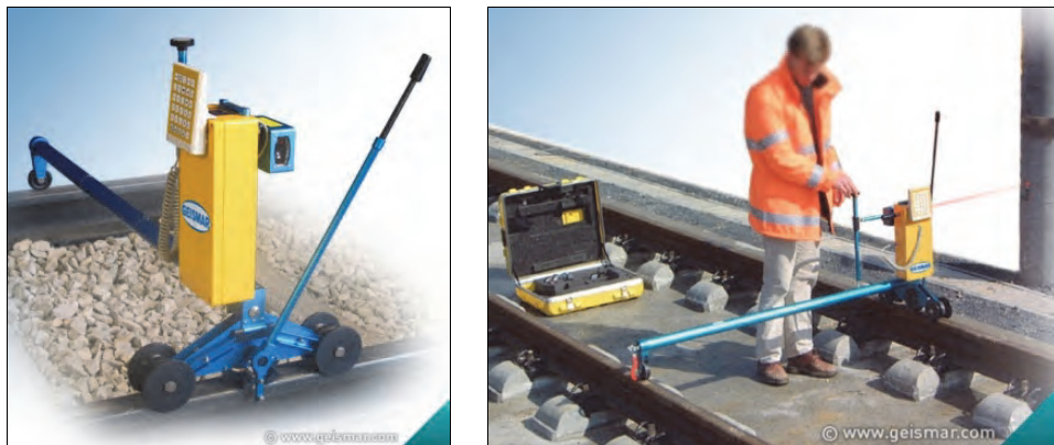
Rys. 5.31. Laserowy pomiar położenia osi toru przyrzędem firmy Geismar [62]
