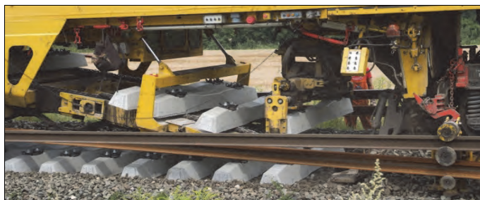
Rys. 9.91. Zespół układania podkładów maszyny RU800 [68]
