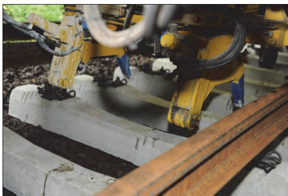
Rys. 9.85. Urządzenie do przesuwania podkładów w torze w maszynie SUZ 500 UVR [68]
