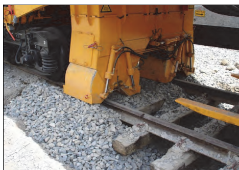
Rys. 6.54. Maszyna VM250 JUMBO – wyładunek tucznia [68]
