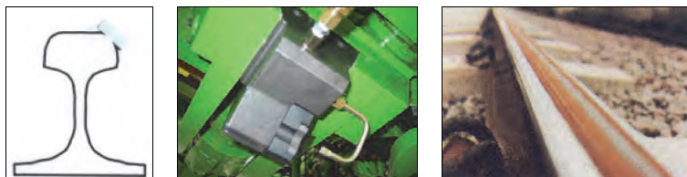
Rys. 8.51. Obróbka krawędzi tocznej główki szyny – promień wyokrąglenia [68]
