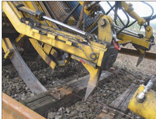
Rys. 9.82. Zespół wyjmowania starych podkładów w maszynie SUZ 500 UVR [68]
