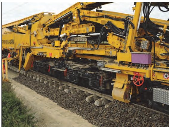
Rys. 11.51. Wsypanie tłucznia w tor maszynami PM i RPM [68]
