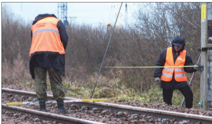
Rys. 5.32. Pomiar odległości znaku od osi toru (J. Zariczny)
