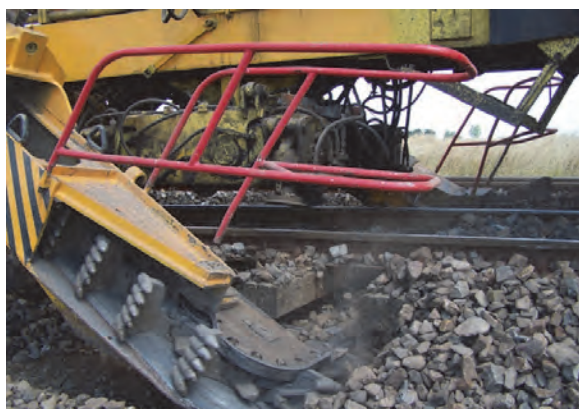
Rys. 6.22. Zespół podnosząco-nasuwający – za belką podtorową (J. Zariczny)
