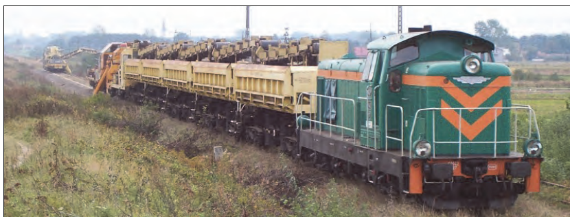
Rys. 6.56. Pociąg do Transportu Odsiewek PTO200 (D. Krysztofiak) [148]
