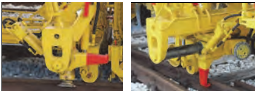
Rys. 5.18. Układ nasuwająco-podnoszący z hakami [67]
