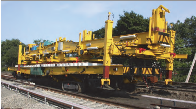
Rys. 10.35. Maszyna WM-40/PK – jazda na podwoziu gąsienicowym [68]
