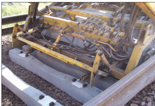
Rys. 9.69. Zespół układania podkładów w zespole PUN (J. Zariczny)
