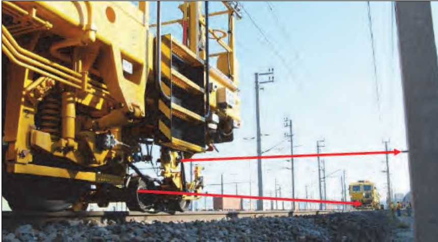
Rys. 5.43. System CAL-SAT współpracujący z podbijką [46]
