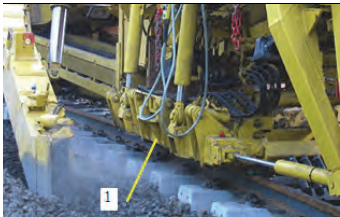
Rys. 6.10. Zespół podnosząco-nasuwający (1) w oczyszczarkach firmy Matisa [67]
