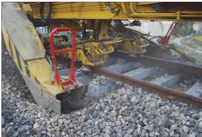
Rys. 6.3. Belka podtorowa połączona z łańcuchem wybierakowym [68]
