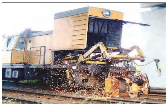
Rys. 7.3. Zgrzewarka PRSM-4 z głowicą zgrzewającą
