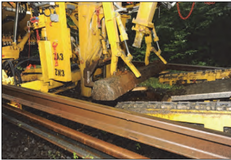
Rys. 9.87. Zespół wybierania podkładów (a); transport wybranej podsypki i nowych podkładów w maszynie SUM-Q3 (b) [68]
