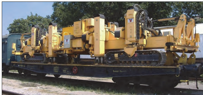
Rys. 9.37. Transport układarki DESEC TL na wagonie [56]
