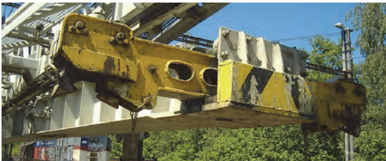
Rys. 9.29. Belka poprzeczna do mocowania przęseł za główkę szyny żurawia UK-25 [81]
