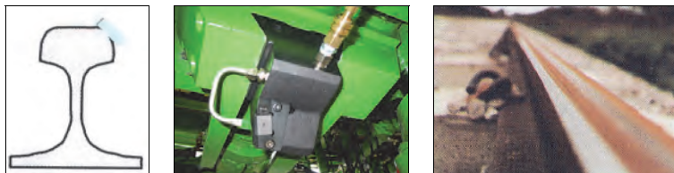
Rys. 8.49. Obróbka krawędzi tocznej główki szyny – kąt 45^\circ [68]
