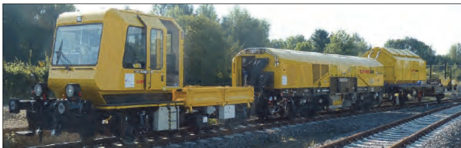
Rys. 8.56. Maszyna D-HOB 2500 do strugania obrotowego [30]
