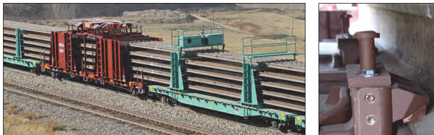
Rys. 9.4. Wagony z automatycznym systemem mocowania szyn [62]
