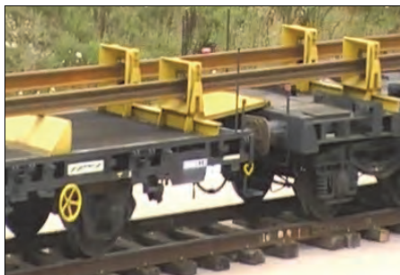
Rys. 9.12. Gniazda, przez które przesuwane są szyny w systemie firmy NEW SOREMA FERROVIARIA [78]
