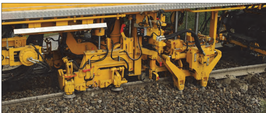
Rys. 11.52. Zespół podnosząco-nasuwiający i podbijający w maszynach PM i RPM [68]
