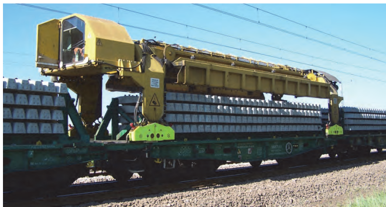
Rys. 9.50. Wagon platformy i suwnica bramowa zespołu PUN (J. Zariczny)
