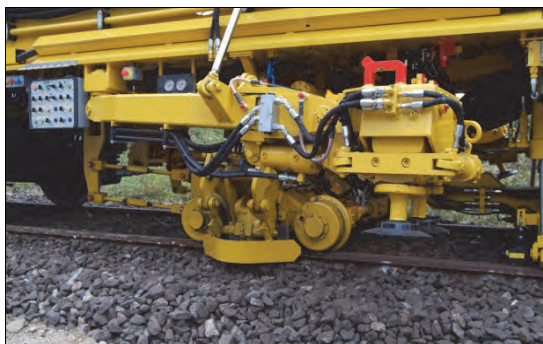
Rys. 6.49. System stabilizacji podsypki na oczyszczarce RM900 HD100 [68]
