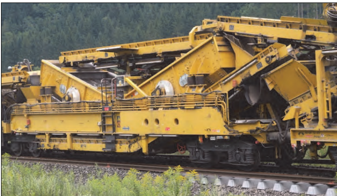
Rys. 9.94. Zespół przesiewaczy podsypki tłuczniowej maszyny RU800 [68]
