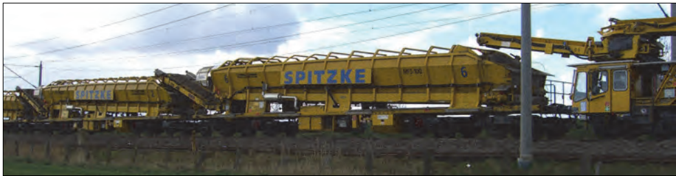
Rys. 11.40. Wagony MFS do transportu odsiewek i wybranej warstwy podtorza [68]
