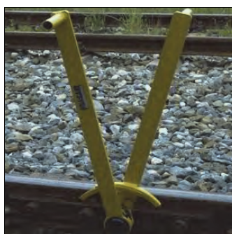
Rys. 3.4. Klucz dwuramienny do śrub [74]
