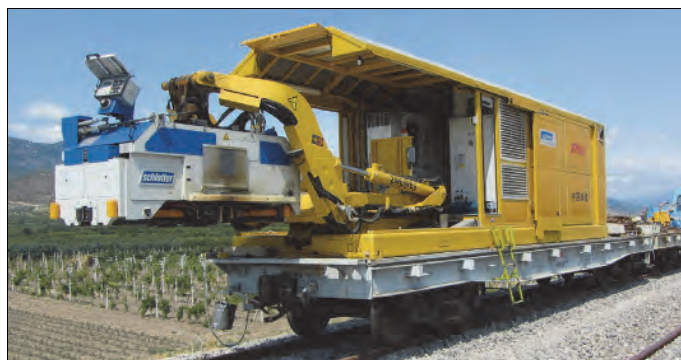
Rys. 7.6. System kontenerowy z głowicą zgrzewającą AMS100 [76]
