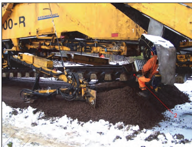
Rys. 11.34. Budowa maszyny AHM 800R: 1 – transporter rozścielający, 2 – wózek zasypowo-zgarniający, 3 – pług, 4 – zespół sześciu płyt wibracyjnych (J. Zariczny)
