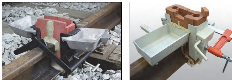
Rys. 7.29. Formy z założonymi tackami żuźlowymi [57, 71]
