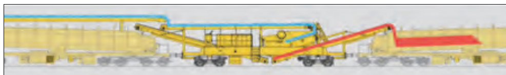
Rys. 6.51. Schemat transportu podsypki w oczyszczarce URM700 [7]: kolor niebieski – zanieczyszczona, zielony – oczyszczona, czerwony – zanieczyszczenia
