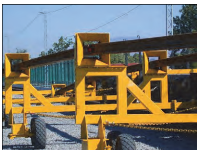
Rys. 9.13. Wózki do wyładunku szyn w systemie firmy NEW SOREMA FERROVIARIA [78]
