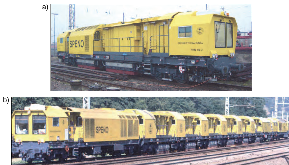
Rys. 8.3. Pociągi do szlifowania szyn firmy SPENO [79]: a) RR16 – do szlifowania rozjazdów; b) RR48 – do szlifowania torów
