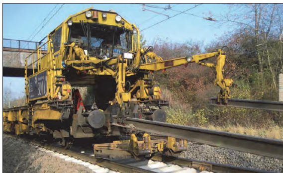
Rys. 9.20. Pociąg SLW do wyładunku i załadunku szyn [82]
