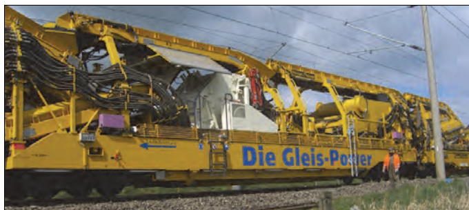
Rys. 11.41. Przesiewacz do wstępnego oczyszczania podsypki i kruszarka w maszynie RPM RS 900 [68]
