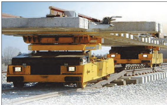
Rys. 10.25. Wózek LEM460 do transportu przęseł torowych i rozjazdowych [62]
