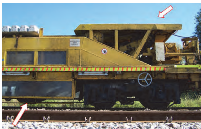
Rys. 9.57. Transporter magnetyczny i wózek z wychylnym pojemnikiem zespołu PUN (J. Zariczny)
