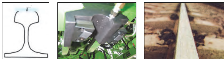
Rys. 8.53. Obróbka krawędzi toczonej główki szyny – kąt 0,5^\circ [68]
