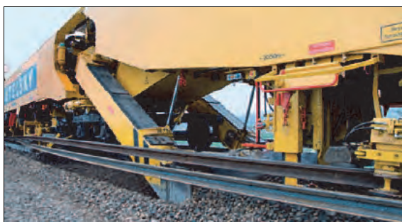
Rys. 9.90. Wybieranie podsypki tłuczniowej przez maszynę RU800 [140]
