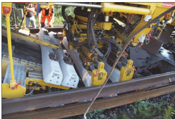
Rys. 9.84. Zespół układania nowych podkładów w maszynie SUZ 500 UVR [68]
