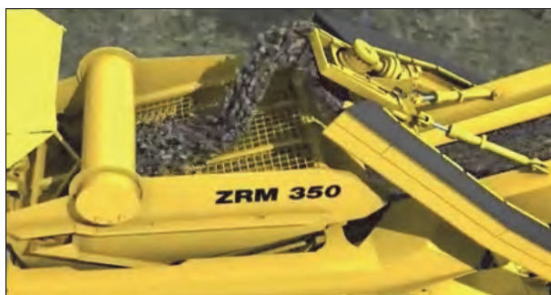
Rys. 6.42. Widok przesiewacza tłuczni oczyszczarki ZRM350 [68]
