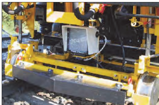
Rys. 5.40. Kamera wykrywająca położenie plamki lasera [46]
