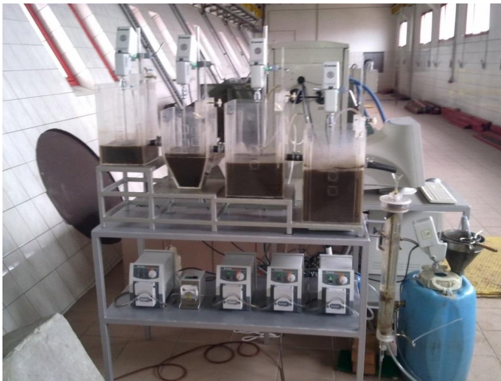
Rysunek 3.3 Widok układu przepływowego JHB podczas pracy w oczyszczalni ścieków „Wschód” w Gdańsku
