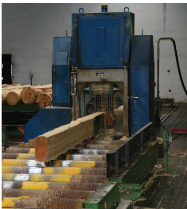
Rysunek 2.1. Trak ramowy DTRB-63 (firmy FOD, PL) w Tartaku "Complex" w Dziemianach [zdjęcie własne]
