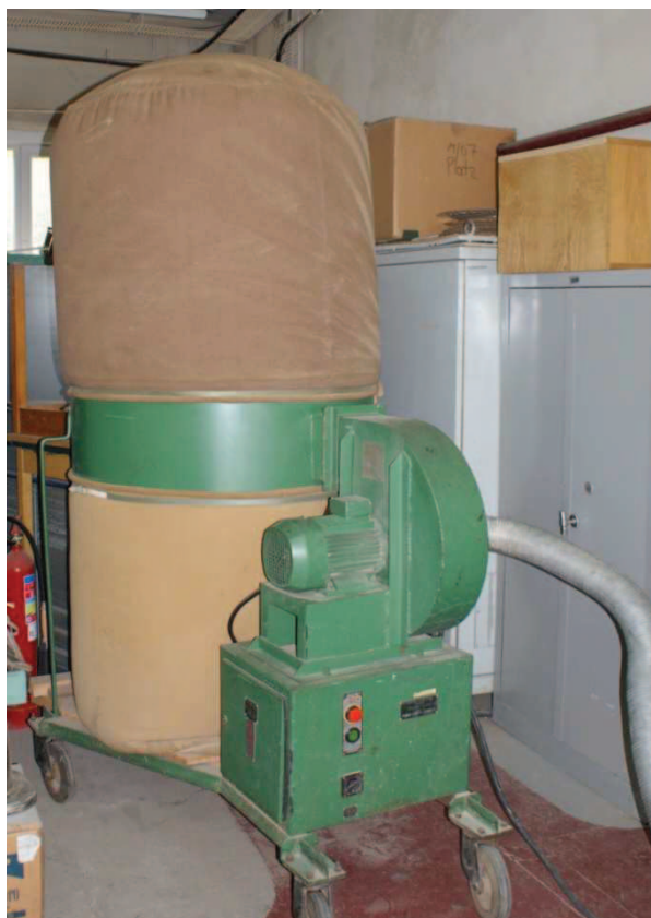
Rysunek 6.4. Układ odsysający trociny [zdjęcie własne]
