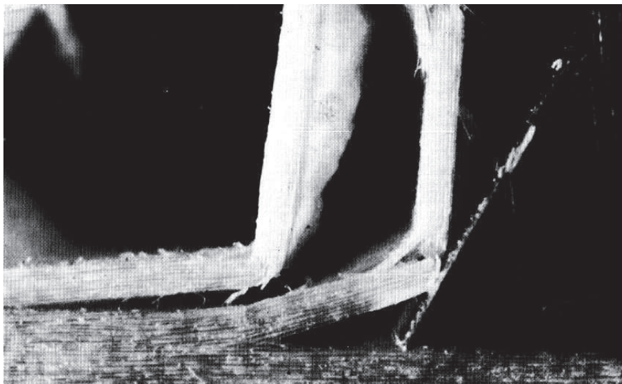
Rysunek 3.8. Wiór typu I według klasyfikacji Franz'a [27]
