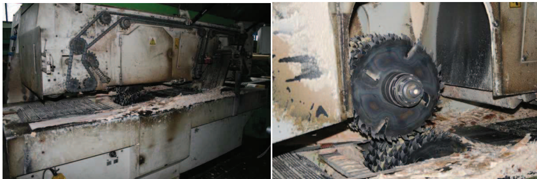
Rysunek 2.6. Pilarka tarczowa PRW 422 (f. TOS Svitavy) w Tartaku "Complex" w Dziemianach. Dwuwrzecionowa, z zamontowanymi dziewięcioma pilami na każdym wrzecionie [zdjęcie własne]
