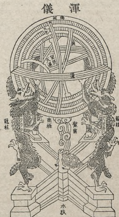
2. Astrolabium umożliwiające wyznaczenie rektascenzji, deklinacji, azymutu wysokości ciał niebieskich ponad horyzontem
