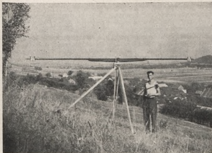
Rys. 7. Precyzyjna łańba bazowa 4-metrowa z drutem inwarowym
