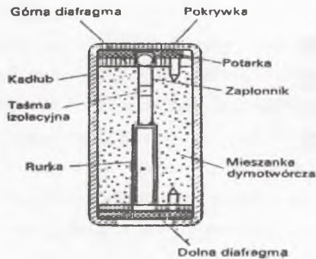
Rys. 16 Przekrój granatu dymnego RGD-2
