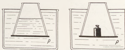
Fig. 4. Abreißen einer Druckplatte durch Wasserdruck und durch Druck eines Gewichtstückes.
