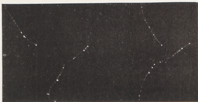
Fig. 3. Die Bahnen von Röntgenstrahlen und \gamma -Strahlen sind selbst nicht als Nebelspur sichtbar; man erkennt sie daran, daß sie ab und zu Elektronen aus den auf ihrem Wege liegenden Molekülen herauswerfen. Die Bahnen dieser Elektronen beginnen alle auf derselben Geraden — durch einen Pfeil angedeutet —, die die Richtung der \gamma bzw. Röntgenstrahlen angibt.
