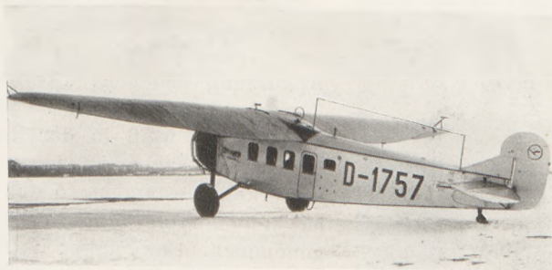
Fig. 18. Antennen eines Flugzeugs.
