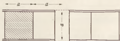
Fig. 1. Querschnitt durch den Spulenträger der selbstgefertigten Selbstinduktion.
