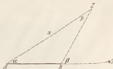
Fig. 3. Verwendung des Spiegelsextanten zur Entfernungsmessung.
