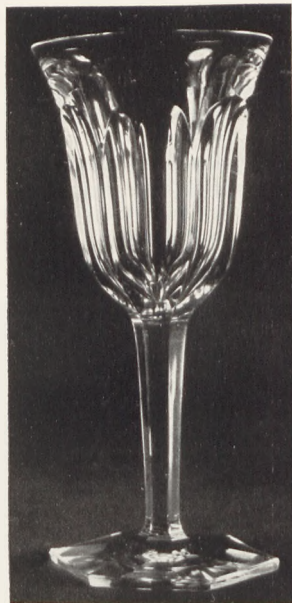
Fig. 4. Weinglas mit sechs Facetten, das für den STADELMANN'Schen Versuch geeignet ist.
