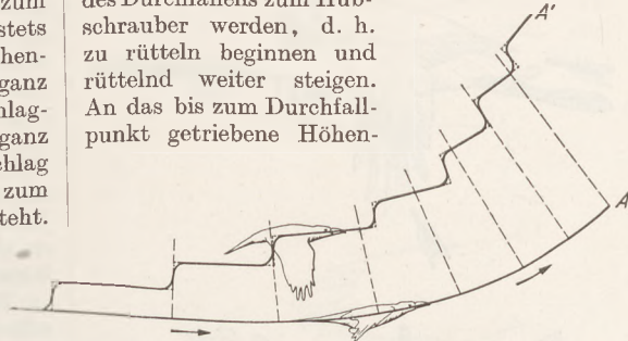
Fig. 5. Schema der Vorgänge beim Geben von Höhensteuer im Gleitrudern. Der Vogel, der bei schlaglosem Gleiten den Punkt A erreichen würde, ehe seine Geschwindigkeit die kleinste Gleitgeschwindigkeit unterschreitet, kann gleitrundernd den Punkt A' erreichen, verlangsamt dabei aber seine Geschwindigkeit ebenso rasch wie beim Gleiten.
