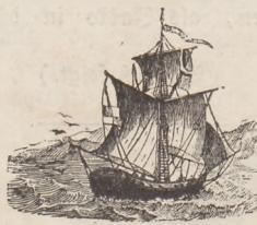
Die nordamerikanische Marine führt jetzt durchgängig Segel aus Baumwollstoff; ihnen schreibt man die größere Geschwindigkeit der amerikanischen Schnellsegler (Clippers) zu. Das weniger poröse Baumwollsegel leistet dem Winde größeren Widerstand und treibt den Riel um einen Knoten in der Stunde weiter als das Flachs- oder Hanfsegel.
