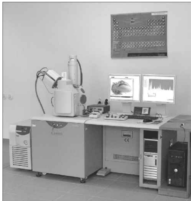
Rys. 1. Elektroniczny mikroskop skaningowy HITACHI S-3400N (SEM) wyposażony w mikroanalizator
