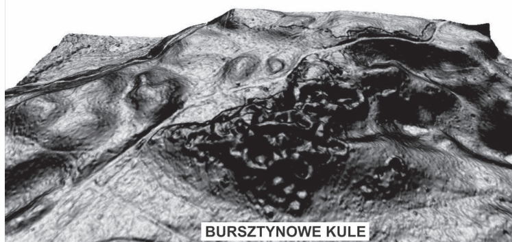
Ryc. 1. Wizualizacja rzeźby powierzchni terenu obszaru poeksploatacyjnego „Bursztynowe Kule” – na podstawie cyfrowych danych wysokościowych pochodzących z lotniczego skaningu laserowego (LIDAR).
