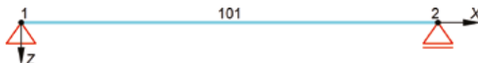
Rys. 3.9. Model belki – dyskretyzacja z zastosowaniem jednego elementu skończonego (niezalecana w obliczeniach praktycznych)
