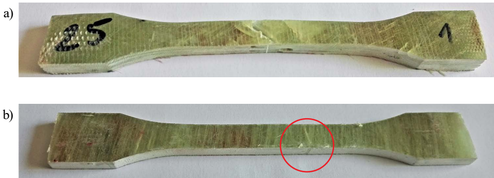
Rys. 5.26. Sposób niszczenia próbek wiosełkowych kompozytu rur: a) dla kąta nawoju \theta = 20^\circ ; b) dla kąta nawoju \theta = 85^\circ . Fot. autor
