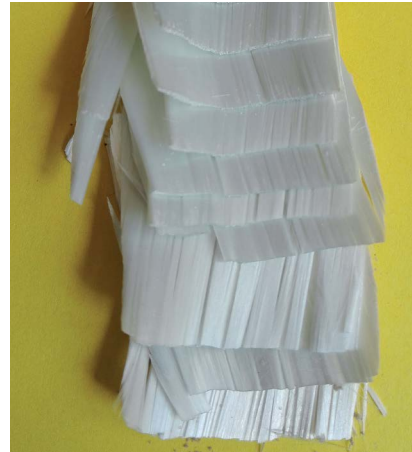
Rys. 5.4. Struktura warstw nawoju włókna szklanego widoczna w próbce kompozytu rury o kącie nawoju 85° po wypaleniu żywicy. Widocznych jest jednaście warstw nawoju o układzie krzyżowym. Fot. autor
