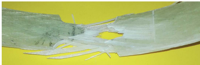
Rys. 5.31. Zbliżenie rozerwanej próbki kompozytu rury o kącie nawoju włókien szklanych \theta = 85^\circ . Widoczne są zarówno włókna zerwane (w osi przewężenia), jak i wyrwane z laminatu (po bokach).
