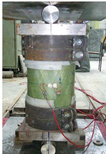
Rys. 5.2. Stanowisko badawcze na Politechnice Gdańskiej. Przygotowana do badań rura kompozytowa pusta o kącie nawoju 20°. Fot. autor
