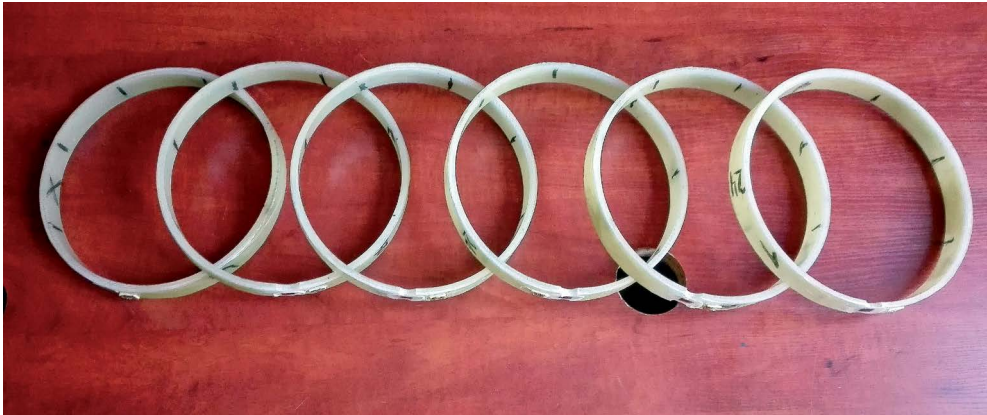
Rys. 5.7. Wycięte z rur obręcze służące do pomiaru grubości ścianki. Fot. autor
