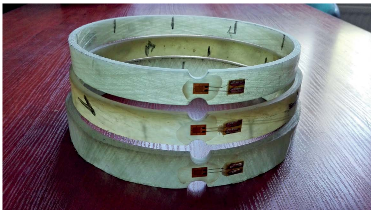
Rys. 5.27. Pierścienie badawcze wycięte z rur o kątach nawoju włókien szklanych \theta = 85^\circ (najwyżej), \theta = 55^\circ (pośrodku) i \theta = 20^\circ (najniżej). Widoczne naklejone tensometry służące do badania modułu sprężystości obwodowej kompozytu. Fot. autor
