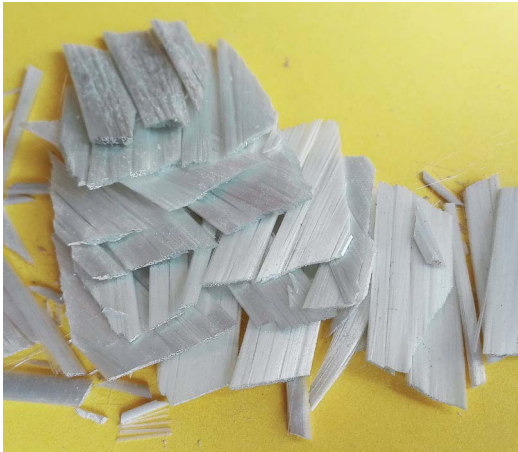
Rys. 5.3. Przemieszane włókna szklane poszczególnych warstw nawoju w próbce kompozytu rury o kącie nawoju 20°. Fot. autor
