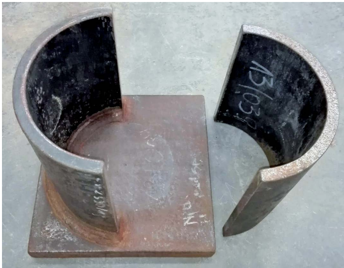
Rys. 5.41. But stalowy używany do badania słupów mimośrodowo ściskanych. Fot. autor
